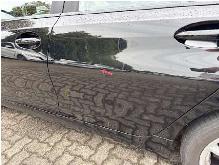
Türe hinten links (Kratzer, Verformung)
