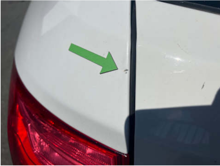
Seitenteil hinten links (Lackschaden)
