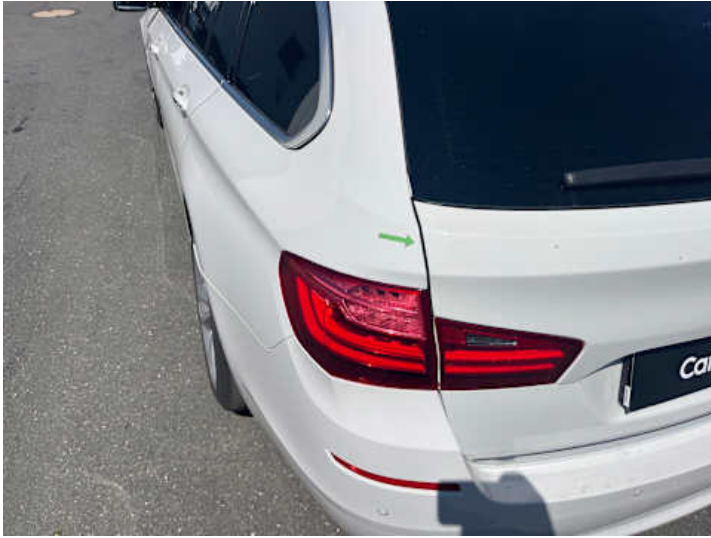
Seitenteil hinten links (Lackschaden)
