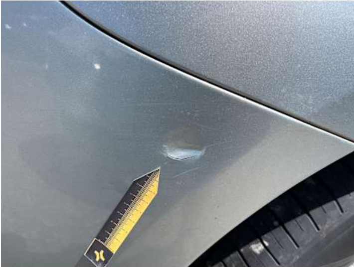
Stoßstange hinten (Lackschaden, Riss/Bruch)
