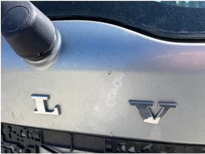
Heckklappe (Kratzer, Lackschaden)
