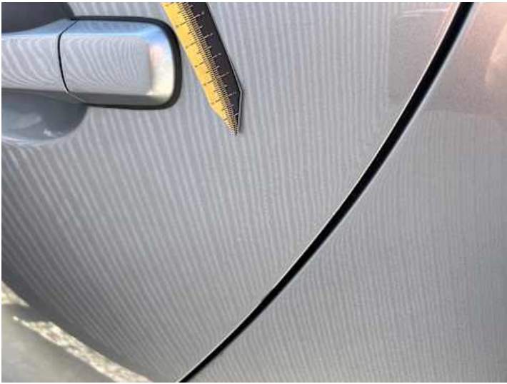
Türe hinten links (Lackschaden, Unsachgemäß instand gesetzt)
