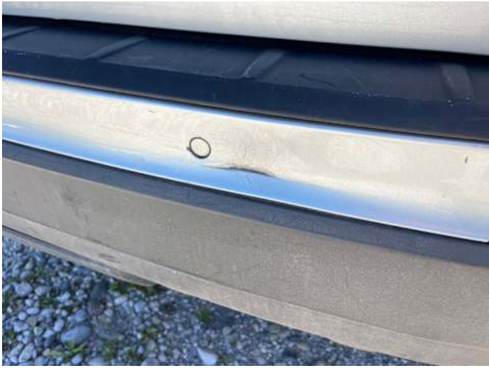
Stoßstange hinten (Kratzer, Lackschaden, Riss/Bruch)
