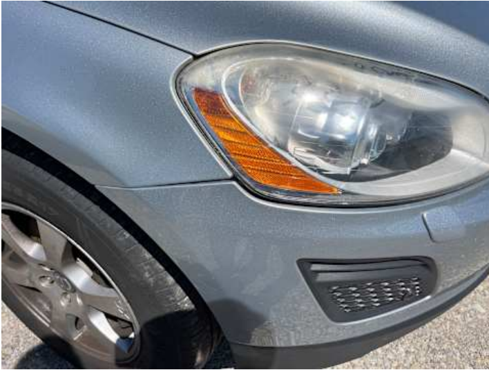
Stoßstange vorne (Spaltmaße ungenau)
