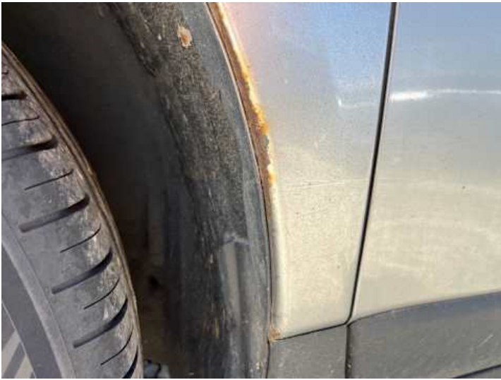
Kotflügel vorne links (Rost, Lackschaden)
