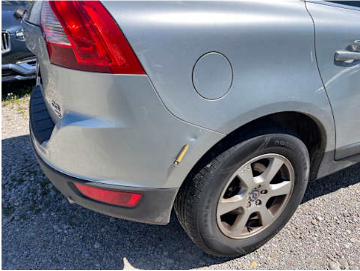
Stoßstange hinten (Lackschaden, Riss/Bruch)
