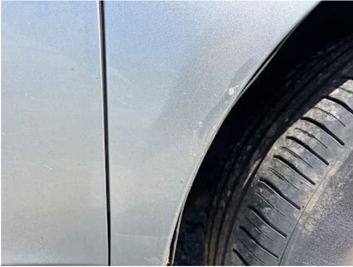
Kotflügel vorne rechts (Lackschaden, Rost)
