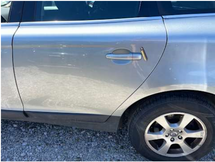
Türe hinten links (Lackschaden, Unsachgemäß instand gesetzt)
