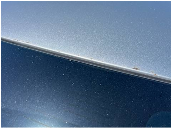
Dach (Steinschlag, Lackschaden)
