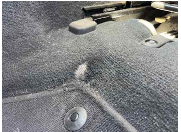
Innenraum (Brandloch, Diverse Schäden)
