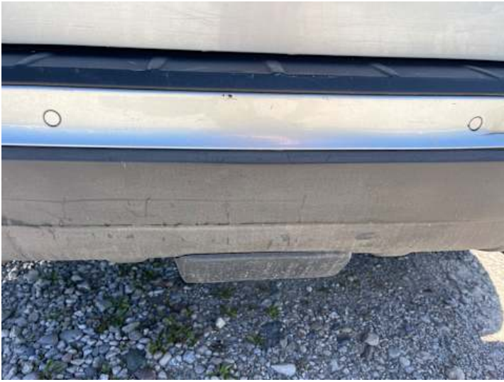
Stoßstange hinten (Kratzer, Lackschaden, Riss/Bruch)
