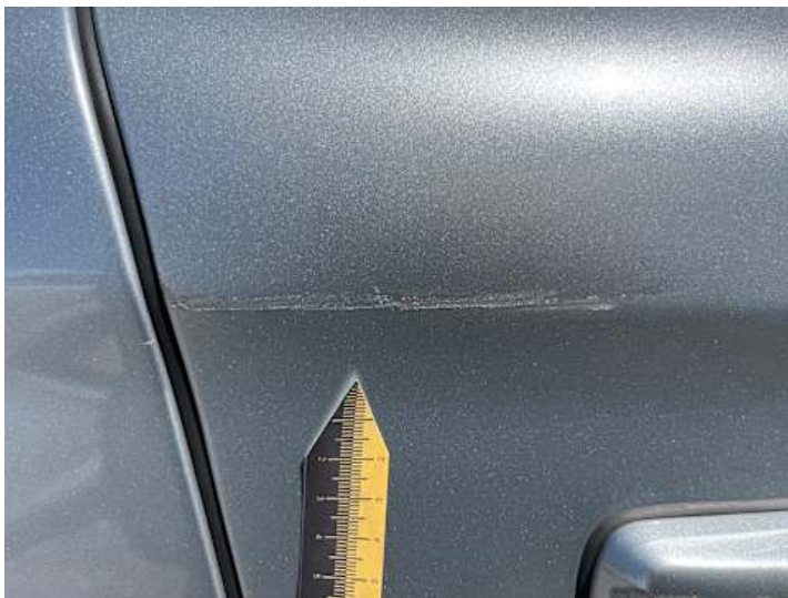
Beifahrertür (Lackschaden, Kratzer, Unsachgemäß instand gesetzt)
