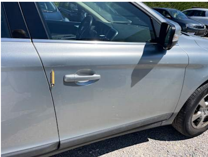
Beifahrertür (Lackschaden, Kratzer, Unsachgemäß instand gesetzt)
