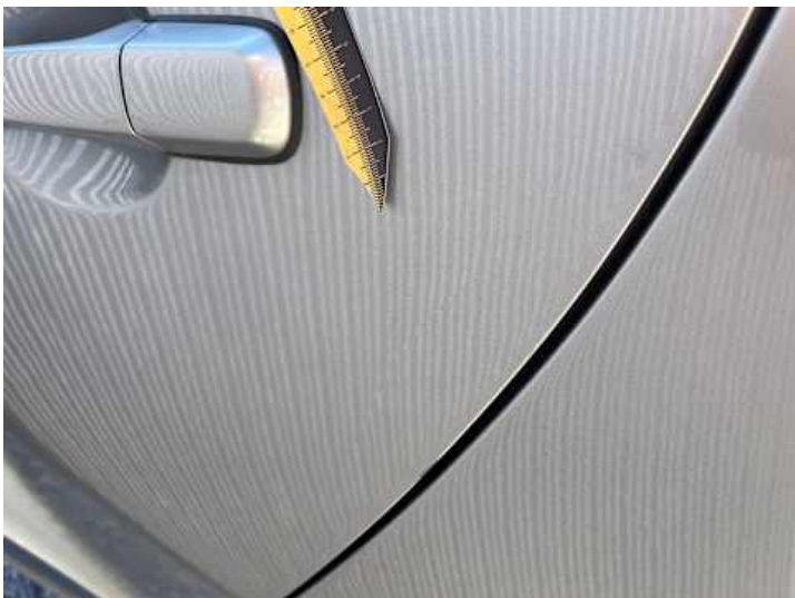
Türe hinten links (Lackschaden, Unsachgemäß instand gesetzt)
