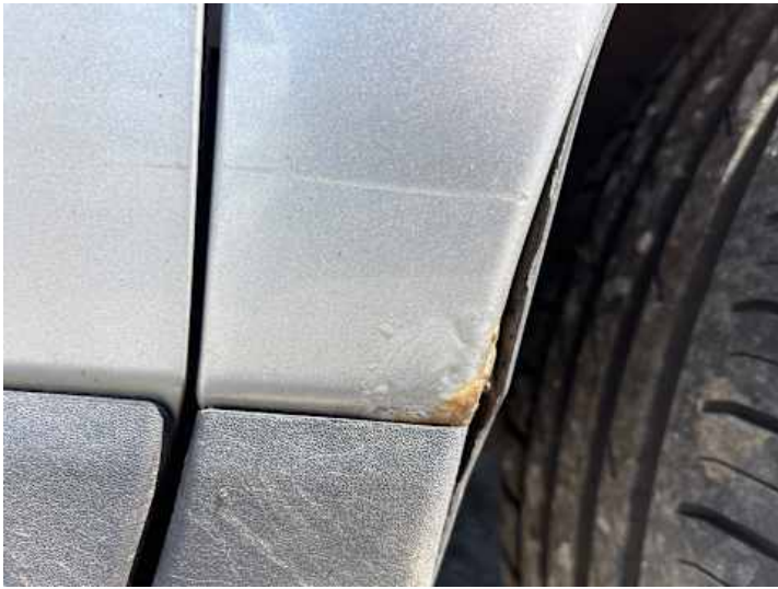
Kotflügel vorne rechts (Lackschaden, Rost)
