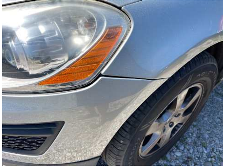
Stoßstange vorne (Spaltmaße ungenau)
