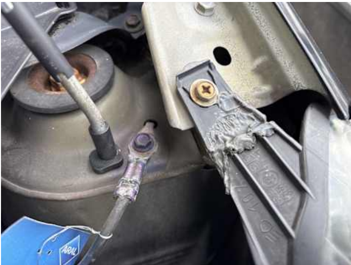
Scheinwerfer (links) (Anderer Schaden): Ungleichmäßig instandgesetzt
