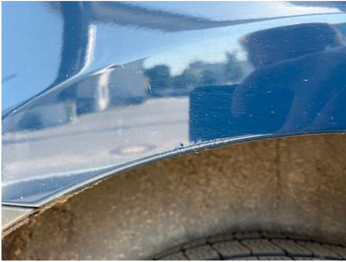
Seitenteil hinten rechts (Kratzer, Lackschaden, Rost)
