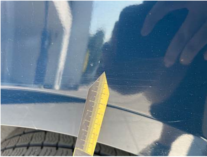
Seitenteil hinten rechts (Kratzer, Lackschaden, Rost)
