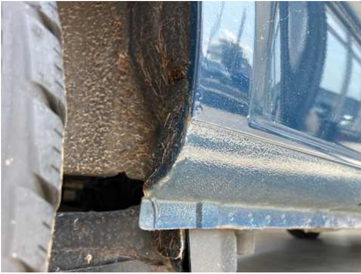
Schweller rechts (Rost, Lackschaden)
