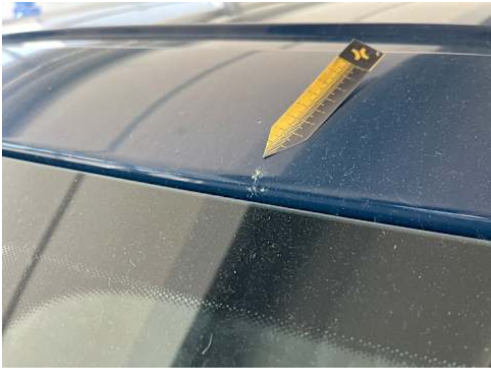
Dach (Steinschlag, Rost)
