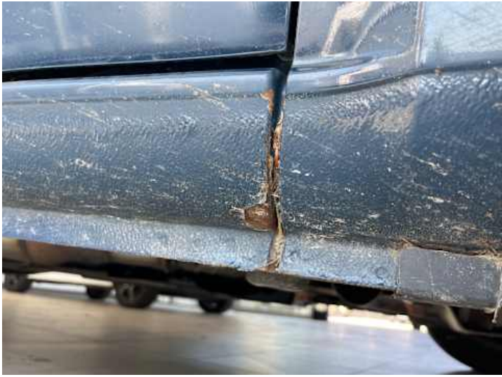
Schweller rechts (Rost, Lackschaden)
