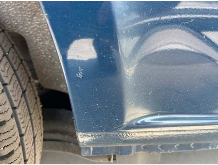
Seitenteil hinten rechts (Kratzer, Lackschaden, Rost)
