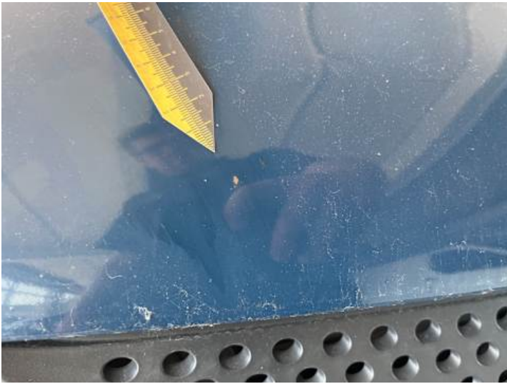
Motorhaube (Steinschlag, Verformung)
