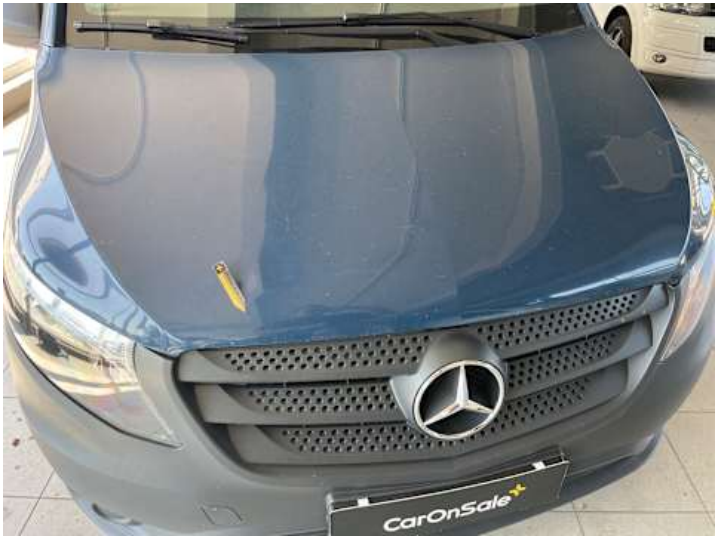
Motorhaube (Steinschlag, Verformung)
