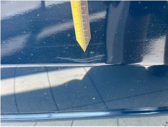
Türe hinten rechts (Kratzer, Lackschaden)
