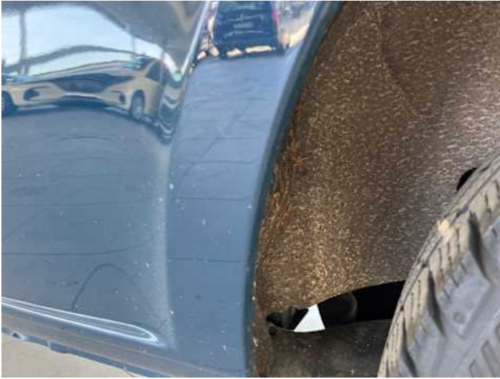
Seitenteil hinten links (Lackschaden, Rost)
