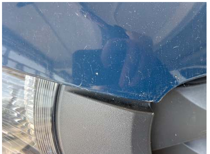
Motorhaube (Steinschlag, Verformung)
