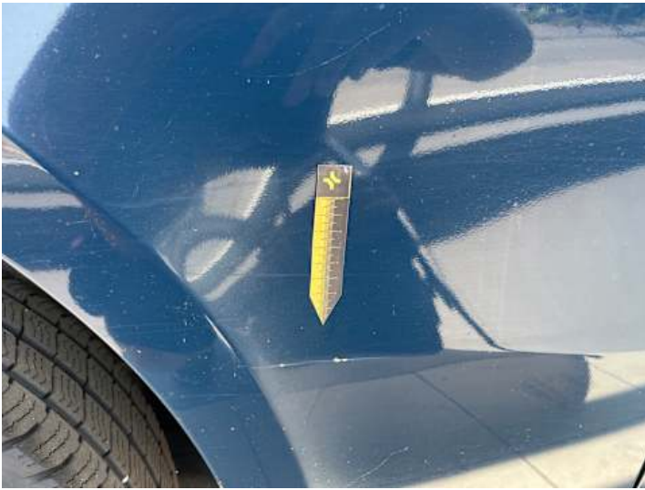
Seitenteil hinten rechts (Kratzer, Lackschaden, Rost)
