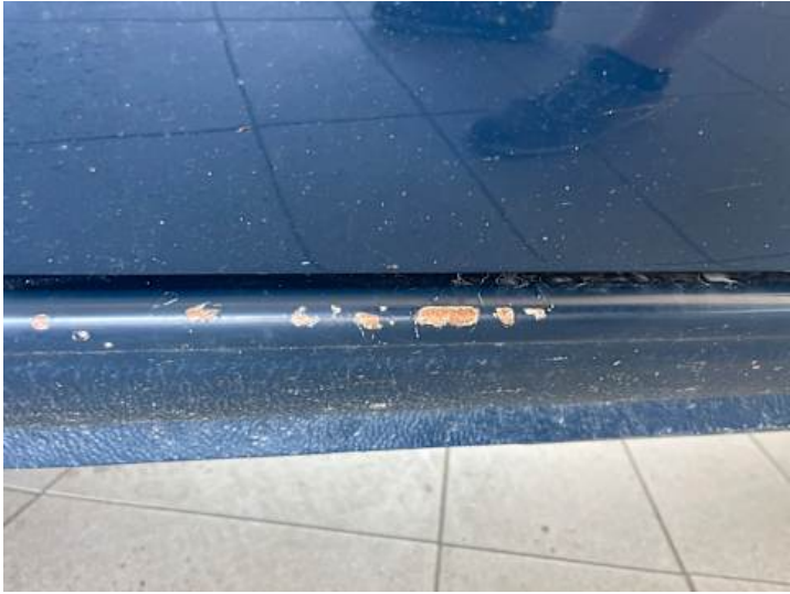
Schweller links (Rost, Lackschaden)
