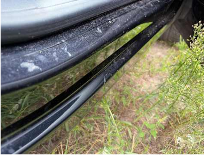
Schweller rechts (Kratzer)
