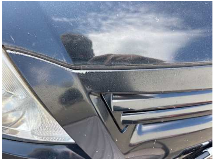
Stoßstange vorne (Kratzer, Unsachgemäß instand gesetzt, Lackschaden)
