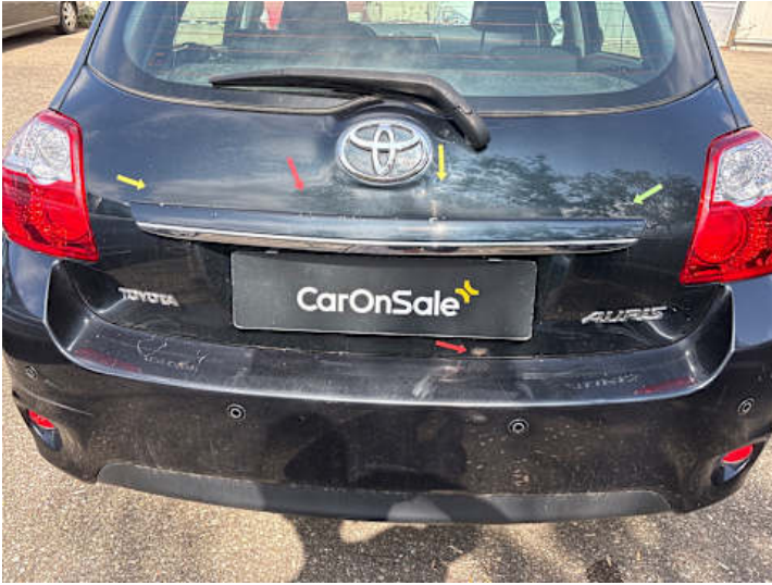
Heckklappe (Rost, Ausgeblichen/Matt, Kratzer, Delle)
