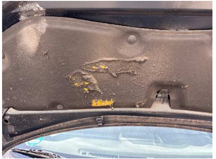
Motorhaube (Anderer Schaden): Dämmmatte angefressen
