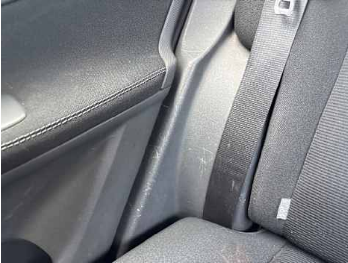
Innenraum (Verschmutzung, Kratzer)
