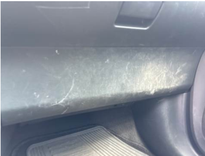
Innenraum (Verschmutzung, Kratzer)
