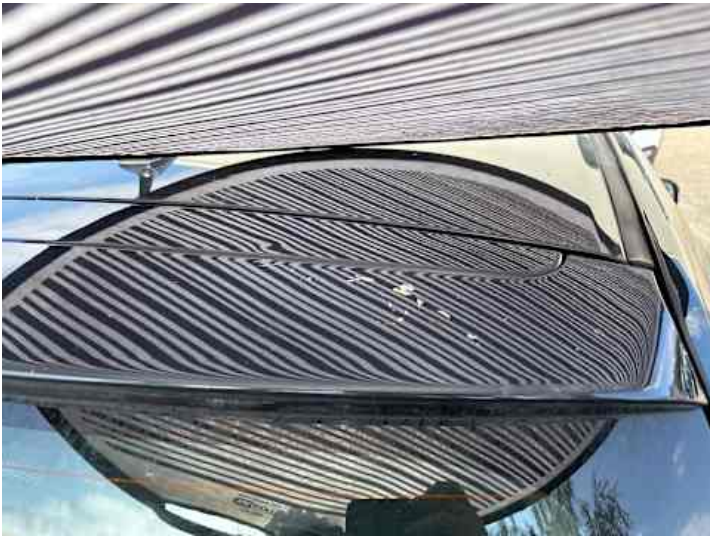
Heckklappe (Rost, Ausgeblichen/Matt, Kratzer, Delle)
