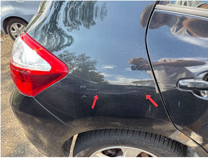
Seitenteil hinten rechts (Rost, Ausgeblichen/Matt)
