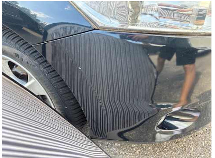
Stoßstange vorne (Kratzer, Unsachgemäß instand gesetzt, Lackschaden)
