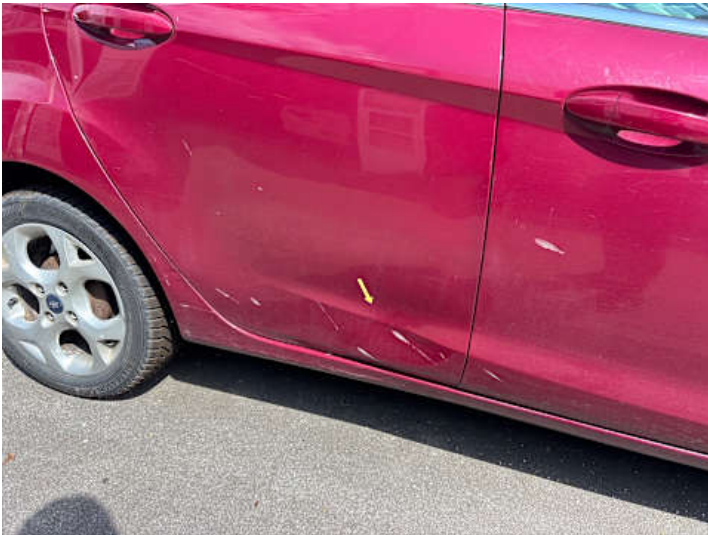
Türe hinten rechts (Delle, Verformung)
