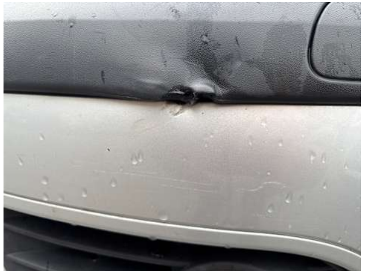
Stoßstange vorne (Kratzer, Riss/Bruch)
