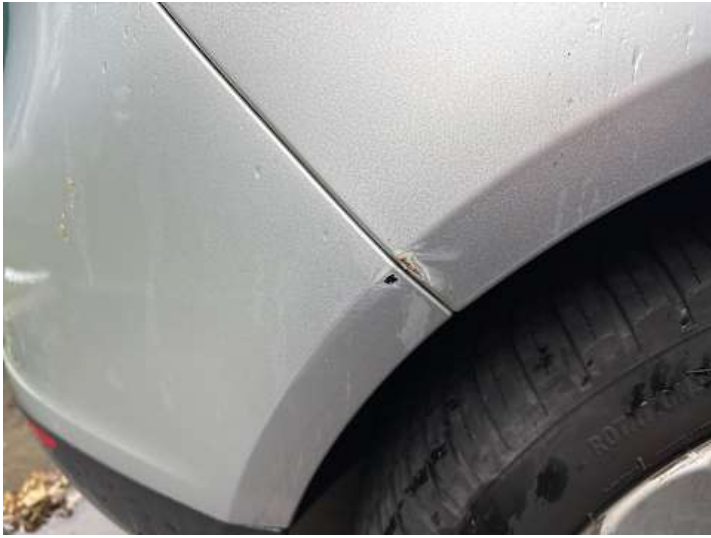
Stoßstange hinten (Kratzer)
