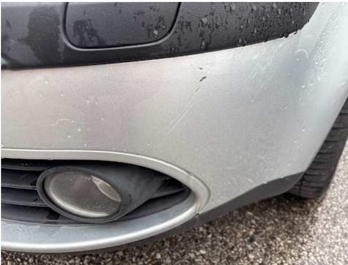
Stoßstange vorne (Kratzer, Riss/Bruch)
