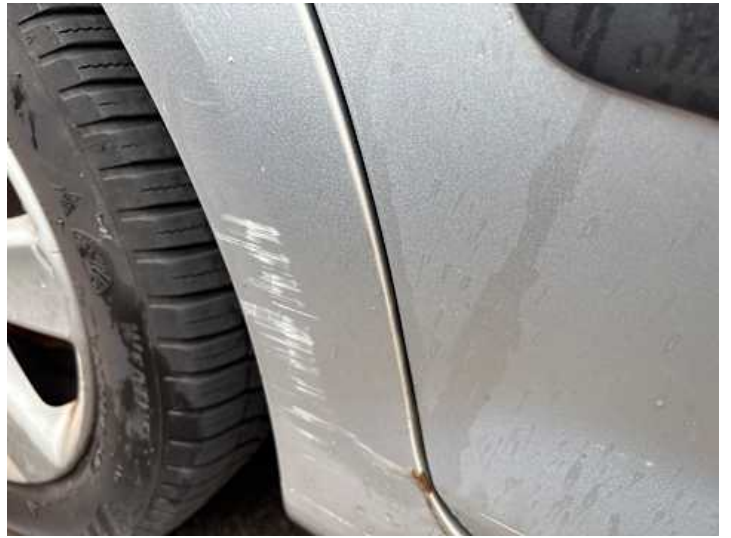
Seitenteil hinten rechts (Kratzer, Verformung)
