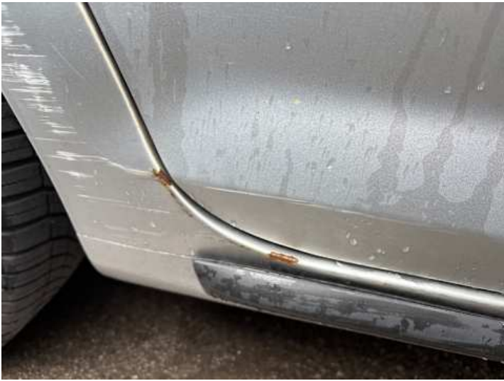
Schweller rechts (Rost, Kratzer)
