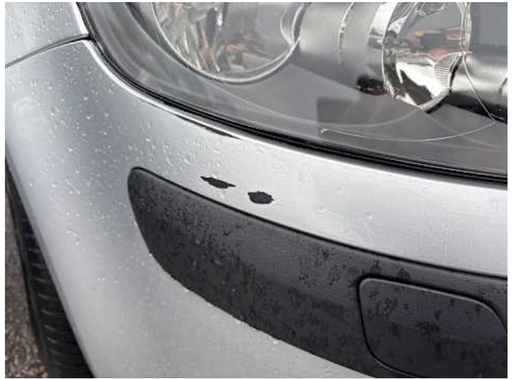
Stoßstange vorne (Kratzer, Riss/Bruch)
