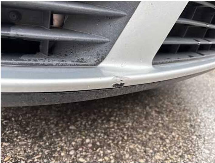
Stoßstange vorne (Kratzer, Riss/Bruch)
