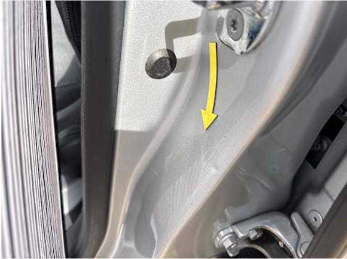
Schweller links (Delle, Kratzer)
