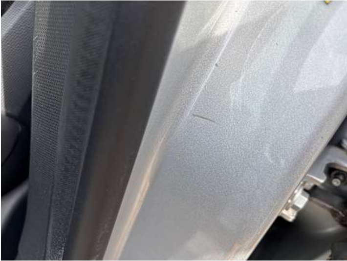
Schweller links (Delle, Kratzer)
