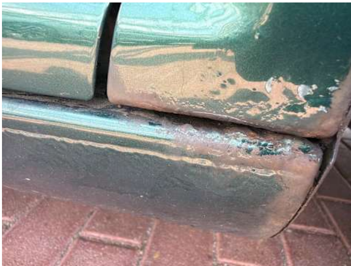
Schweller rechts (Rost, Kratzer)
