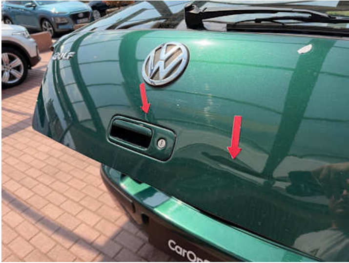
Heckklappe (Kratzer, Delle, Rost)
