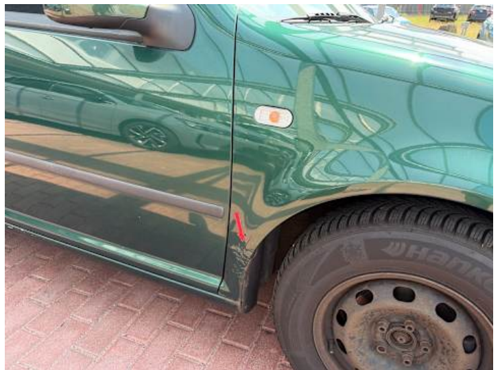
Kotflügel vorne rechts (Rost)
