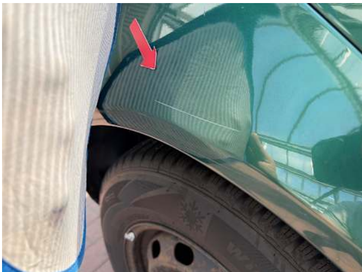
Seitenteil hinten rechts (Kratzer, Delle)
