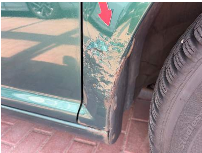
Kotflügel vorne rechts (Rost)
