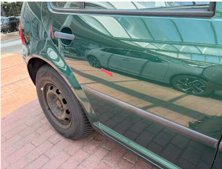
Türe hinten rechts (Kratzer, Delle)
