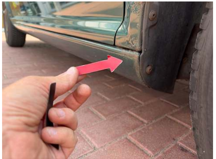
Schweller rechts (Rost, Kratzer)
