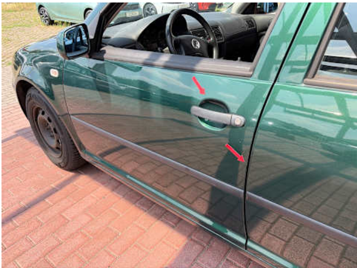
Fahrtür (Kratzer, Rost)
