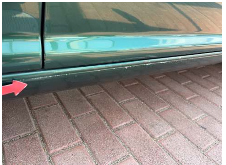
Schweller rechts (Rost, Kratzer)
