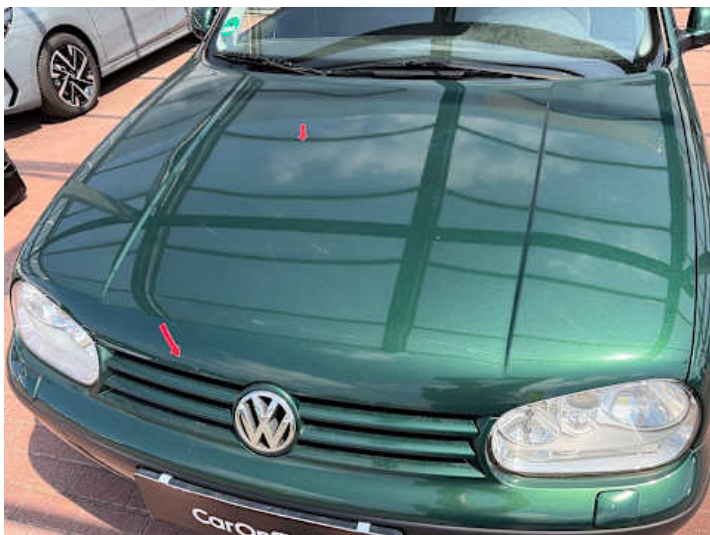
Motorhaube (Kratzer, Steinschlag, Rost)
