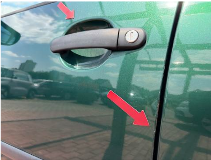
Fahrtür (Kratzer, Rost)
