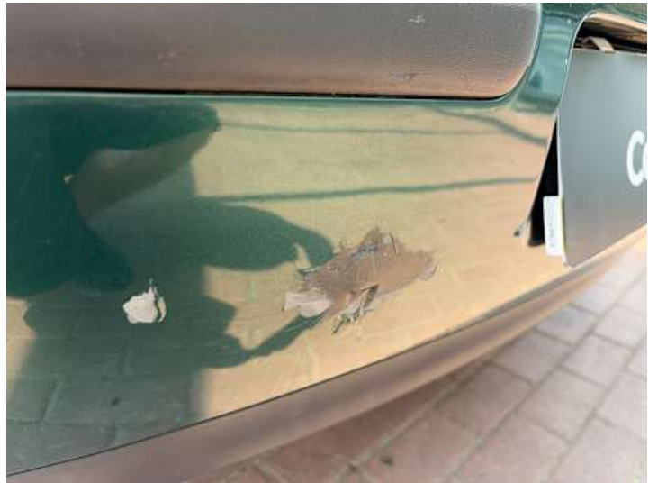
Stoßstange hinten (Kratzer, Riss/Bruch)
