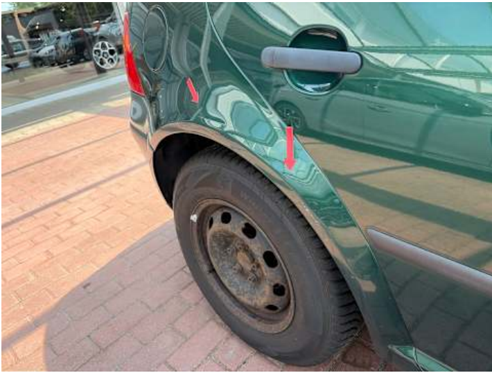
Seitenteil hinten rechts (Kratzer, Delle)
