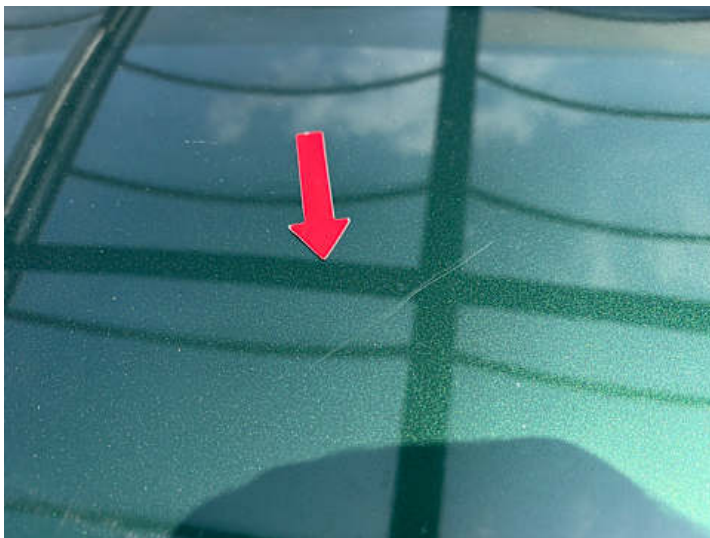
Motorhaube (Kratzer, Steinschlag, Rost)
