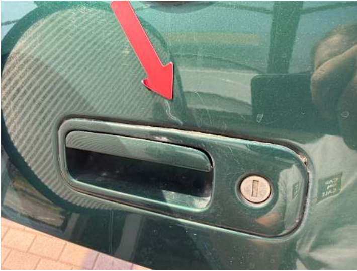
Heckklappe (Kratzer, Delle, Rost)
