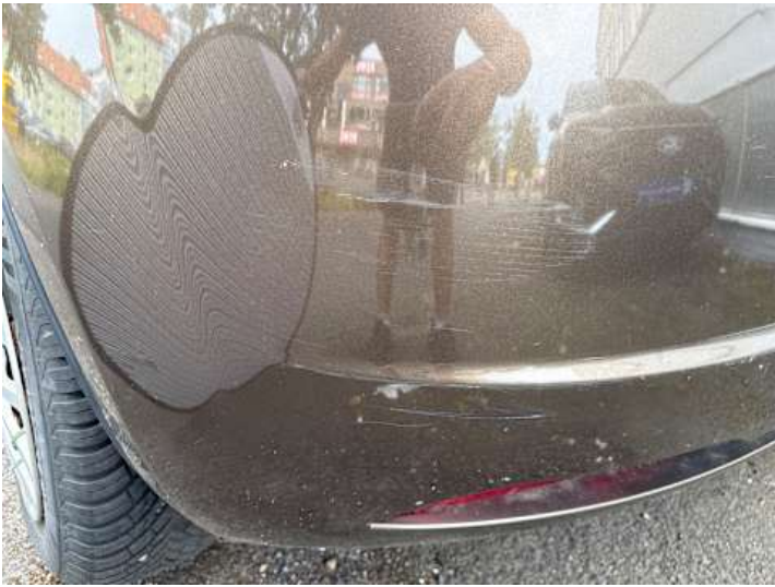
Stoßstange hinten (Kratzer, Delle, Lackschaden)
