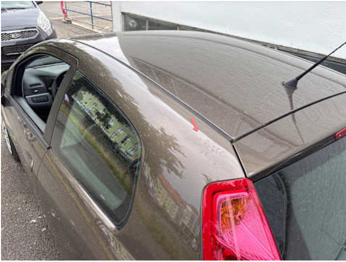
Seitenteil hinten links (Lackschaden)
