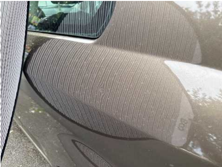
Seitenteil hinten links (Delle)
