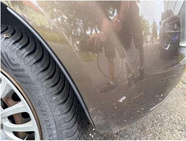
Stoßstange hinten (Kratzer, Delle, Lackschaden)
