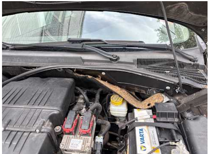
Motorhaube (Anderer Schaden): Dämmung beschädigt
