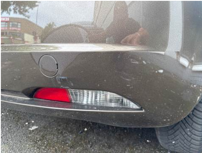
Stoßstange hinten (Kratzer, Delle, Lackschaden)
