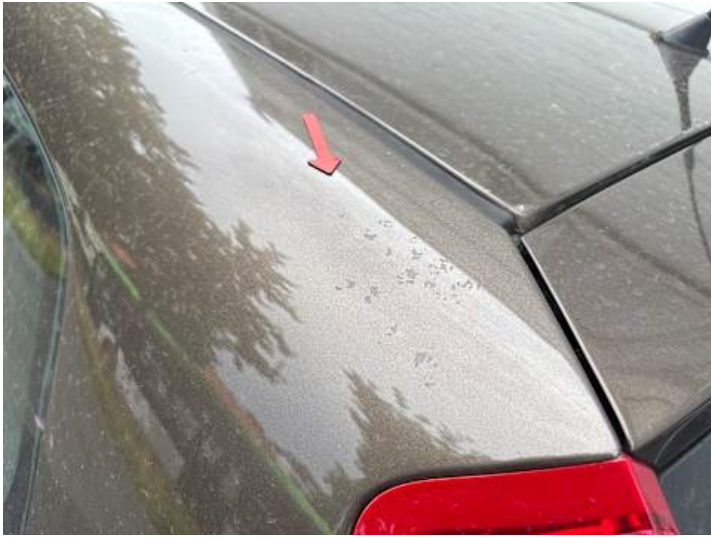
Seitenteil hinten links (Lackschaden)
