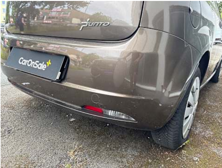
Stoßstange hinten (Kratzer, Delle, Lackschaden)
