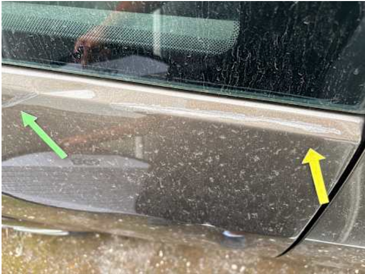
Seitenteil hinten rechts (Kratzer, Lackschaden, Unsachgemäß instand gesetzt, Delle)
