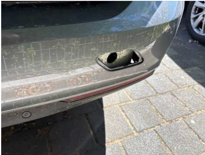
Stoßstange hinten (Anderer Schaden): Fehlt
