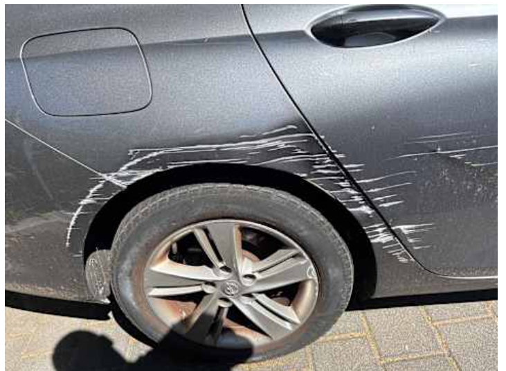
Seitenteil hinten rechts (Kratzer, Verformung)
