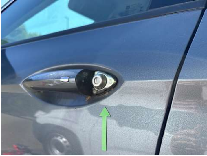
Fahrtür (Anderer Schaden): Kappe fehlt
