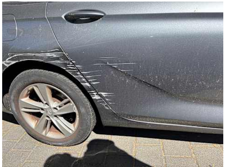
Türe hinten rechts (Kratzer, Verformung)
