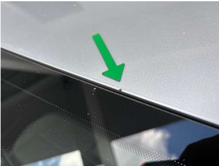
Dach (Kratzer, Rost)
