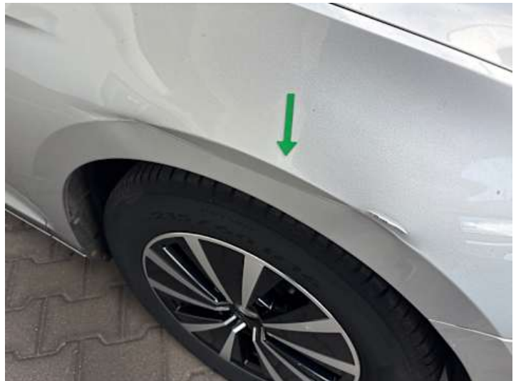
Kotflügel vorne rechts (Verformung, Kratzer)
