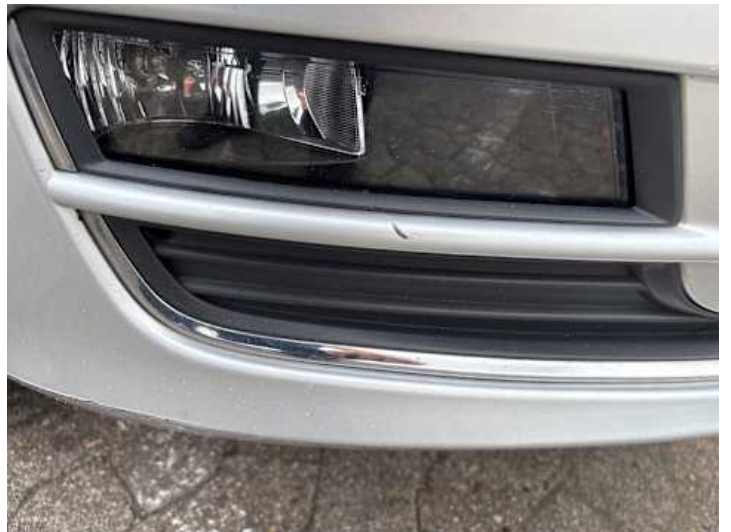
Stoßstange vorne (Kratzer, Lackschaden)
