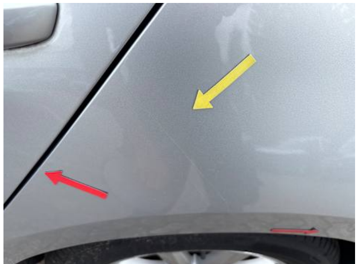
Seitenteil hinten links (Lackschaden, Kratzer, Delle)
