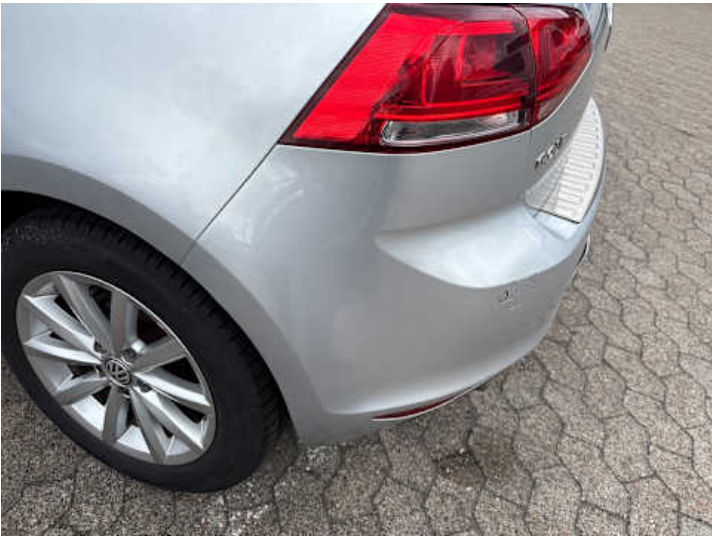
Stoßstange hinten (Lackschaden, Kratzer)
