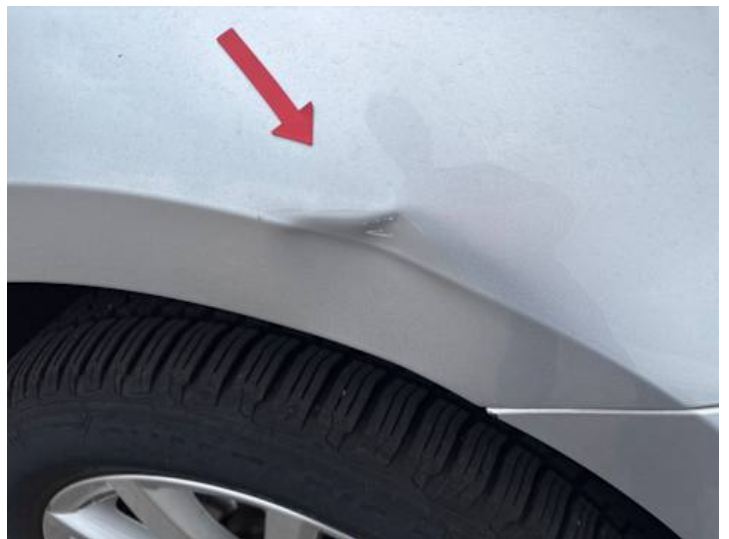
Kotflügel vorne rechts (Verformung, Lackschaden, Delle, Kratzer)
