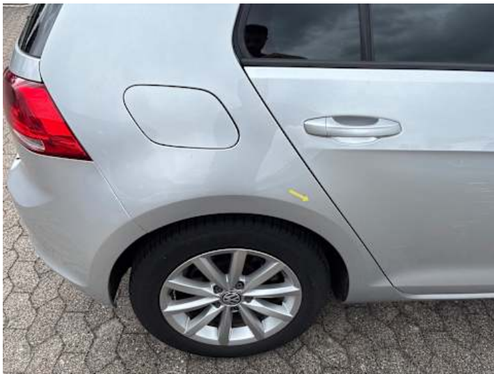
Seitenteil hinten rechts (Kratzer)
