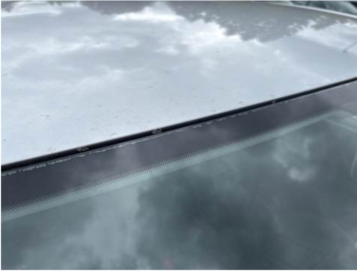
Dach (Lackschaden, Rost)
