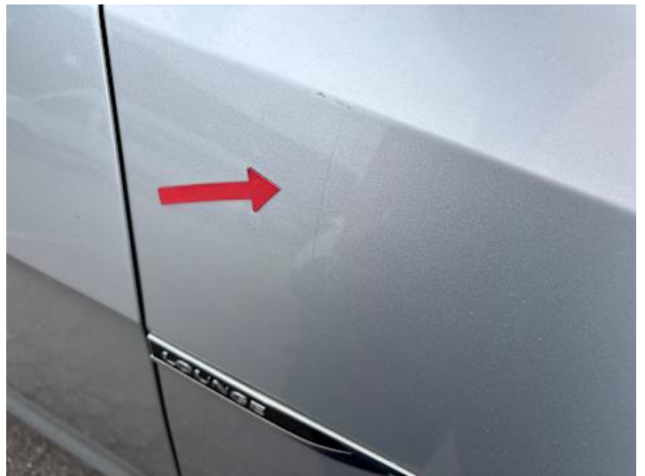
Kotflügel vorne rechts (Verformung, Lackschaden, Delle, Kratzer)
