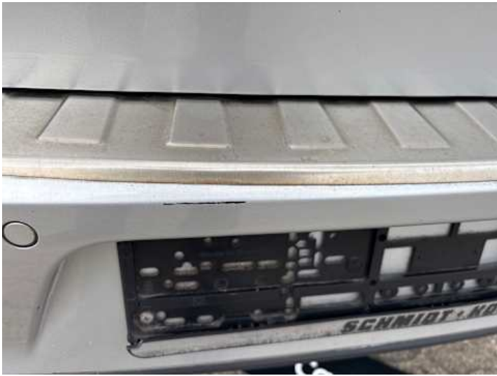
Stoßstange hinten (Lackschaden, Kratzer)
