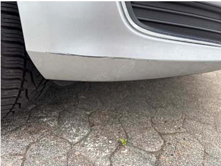
Stoßstange vorne (Kratzer, Lackschaden)
