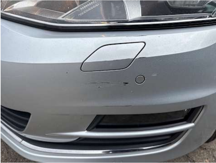
Stoßstange vorne (Kratzer, Lackschaden)
