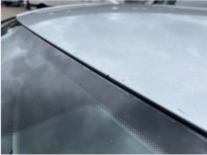
Dach (Lackschaden, Rost)
