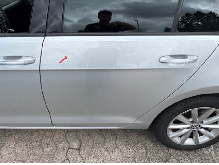
Türe hinten links (Kratzer, Lackschaden)
