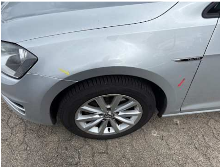
Kotflügel vorne links (Kratzer)
