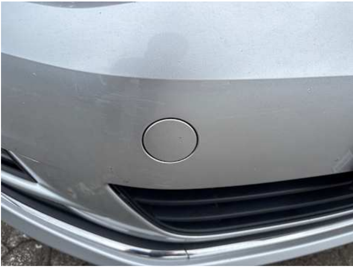
Stoßstange vorne (Kratzer, Lackschaden)
