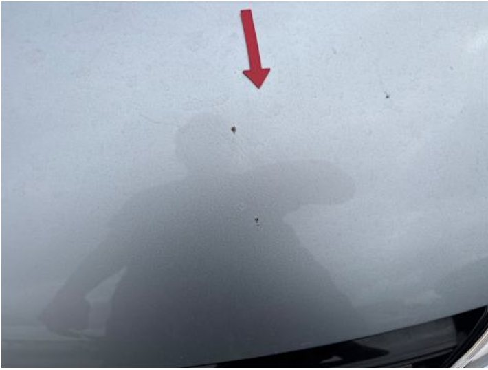
Motorhaube (Steinschlag, Lackschaden)
