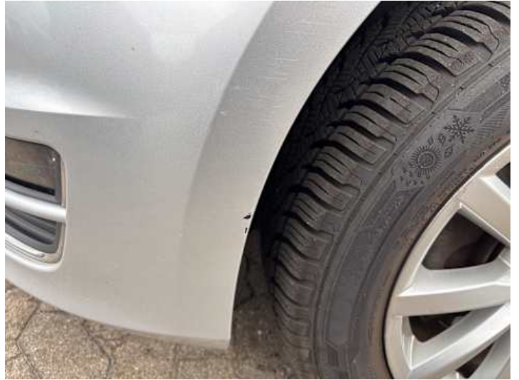
Stoßstange vorne (Kratzer, Lackschaden)
