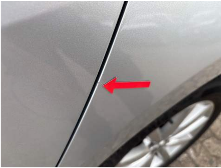
Seitenteil hinten links (Lackschaden, Kratzer, Delle)
