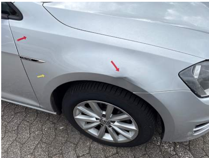
Kotflügel vorne rechts (Verformung, Lackschaden, Delle, Kratzer)
