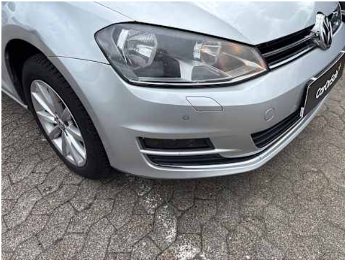
Stoßstange vorne (Kratzer, Lackschaden)
