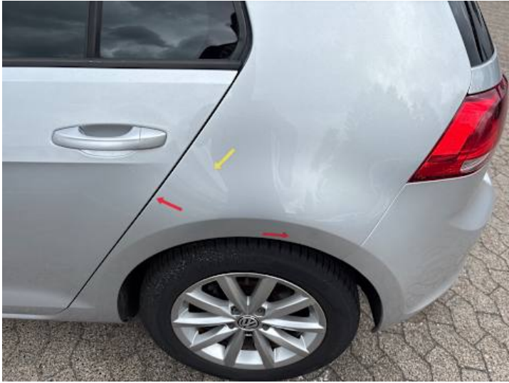
Seitenteil hinten links (Lackschaden, Kratzer, Delle)
