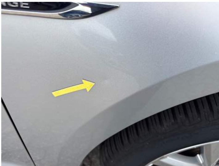
Kotflügel vorne rechts (Verformung, Lackschaden, Delle, Kratzer)
