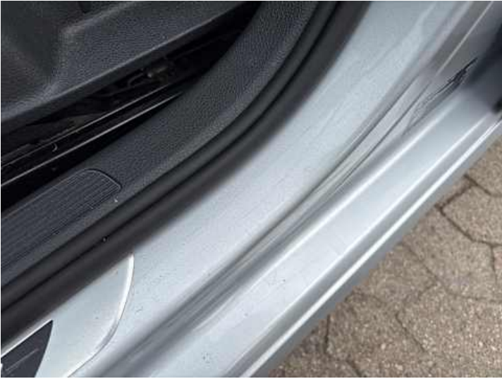
Schweller links (Kratzer, Lackschaden, Delle)
