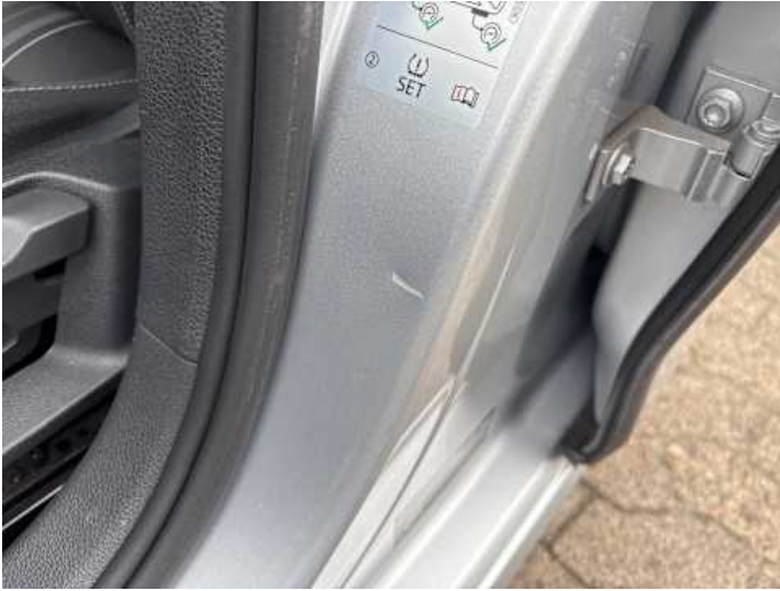
Schweller links (Kratzer, Lackschaden, Delle)
