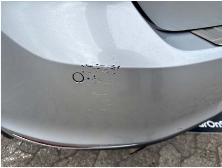
Stoßstange hinten (Lackschaden, Kratzer)
