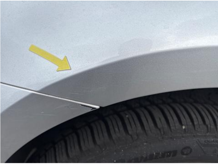
Kotflügel vorne links (Kratzer)
