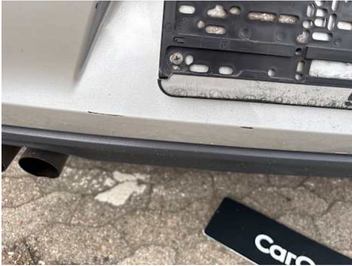
Stoßstange hinten (Lackschaden, Kratzer)
