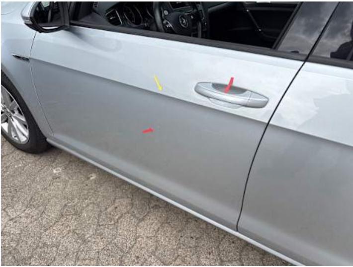
Fahrtür (Kratzer, Lackschaden)
