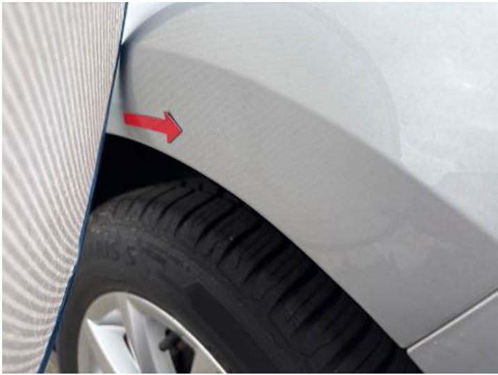
Seitenteil hinten links (Lackschaden, Kratzer, Delle)
