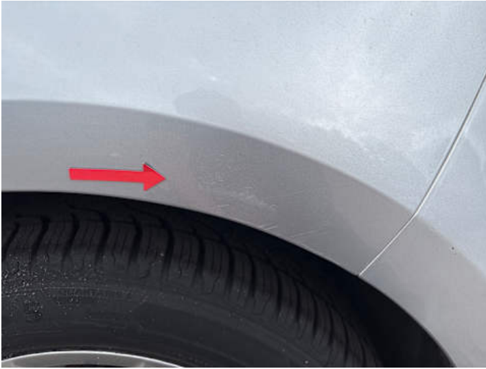
Seitenteil hinten links (Lackschaden, Kratzer, Delle)
