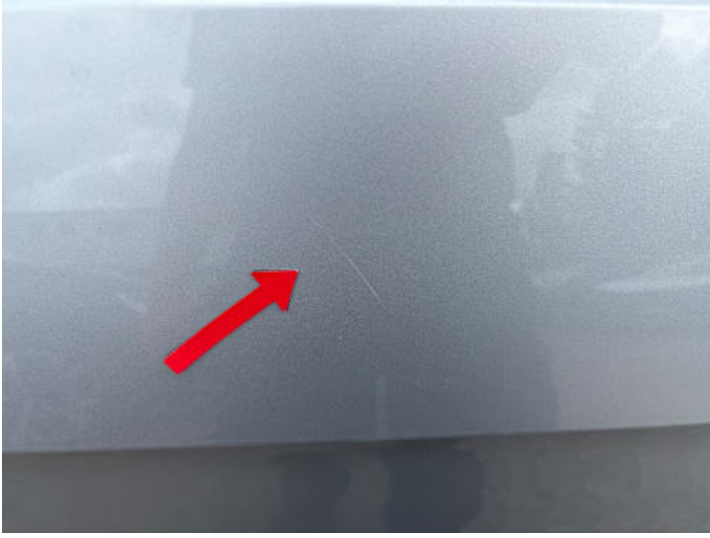
Türe hinten links (Kratzer, Lackschaden)
