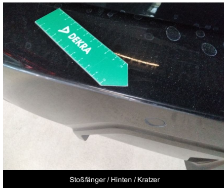
Stoßfänger / Hinten / Kratzer
