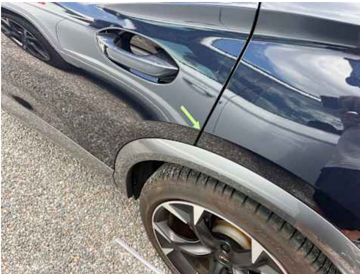
Türe hinten links (Lackschaden)
