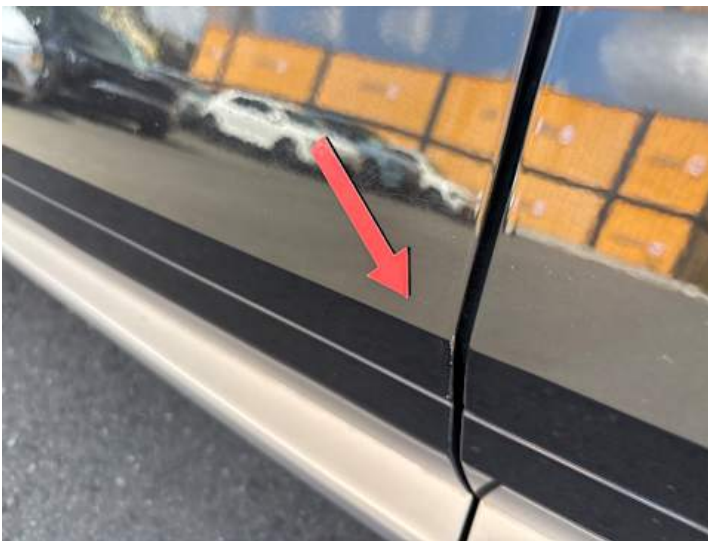
Fahrertür (Lackschaden, Rost)
