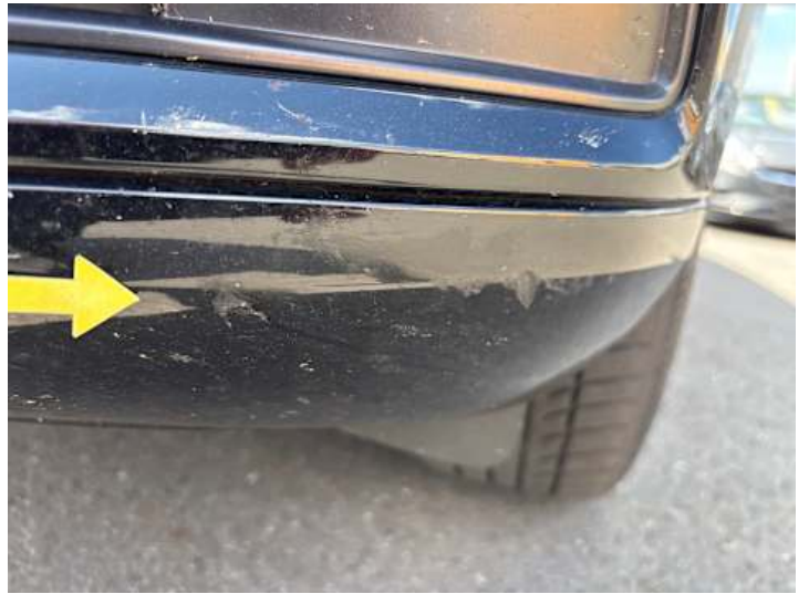
Stoßstange vorne (Delle, Lackschaden)
