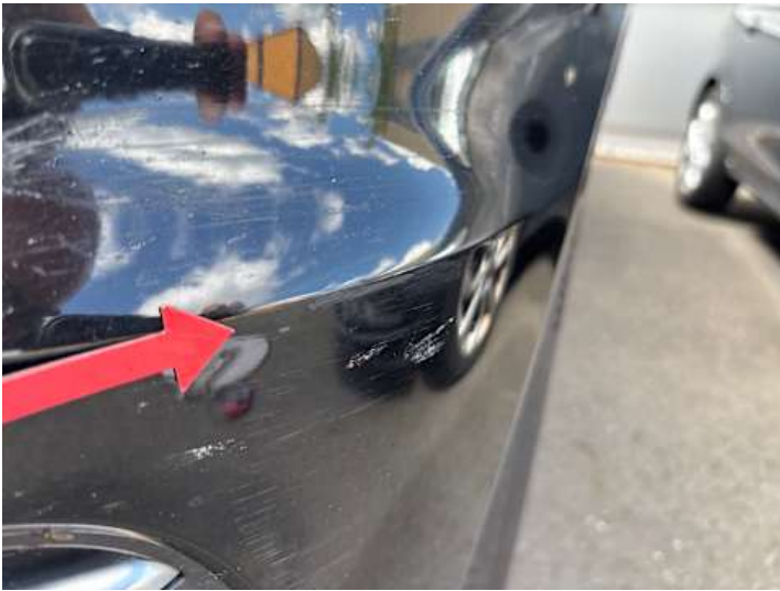
Stoßstange vorne (Kratzer, Lackschaden)
