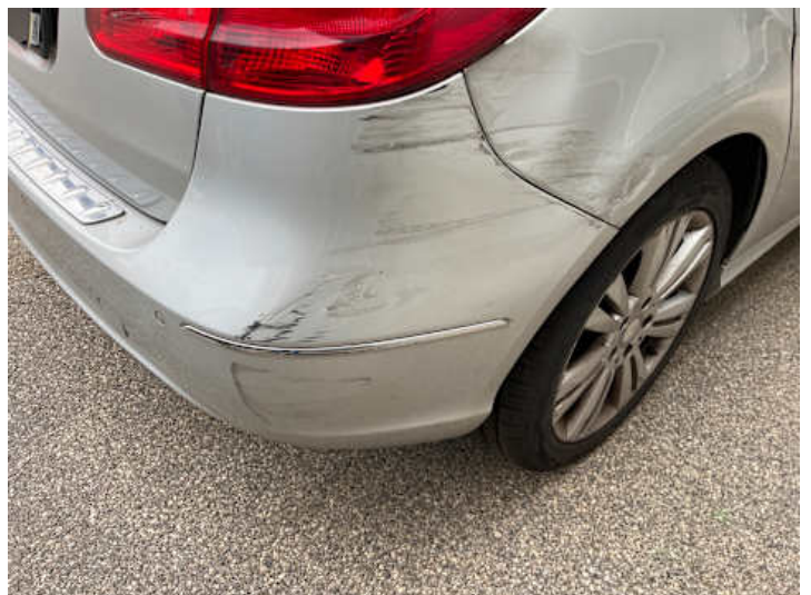
Stoßstange hinten (Delle, Kratzer)
