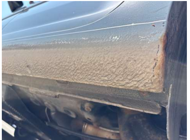
Schweller links (Rost)
