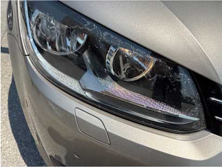
Scheinwerfer (rechts) (Anderer Schaden): Klarlack geht runter
