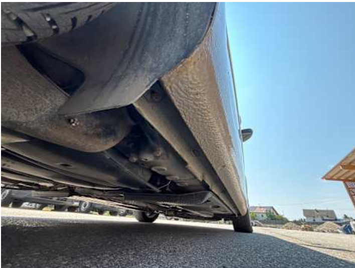
Schweller rechts (Rost)
