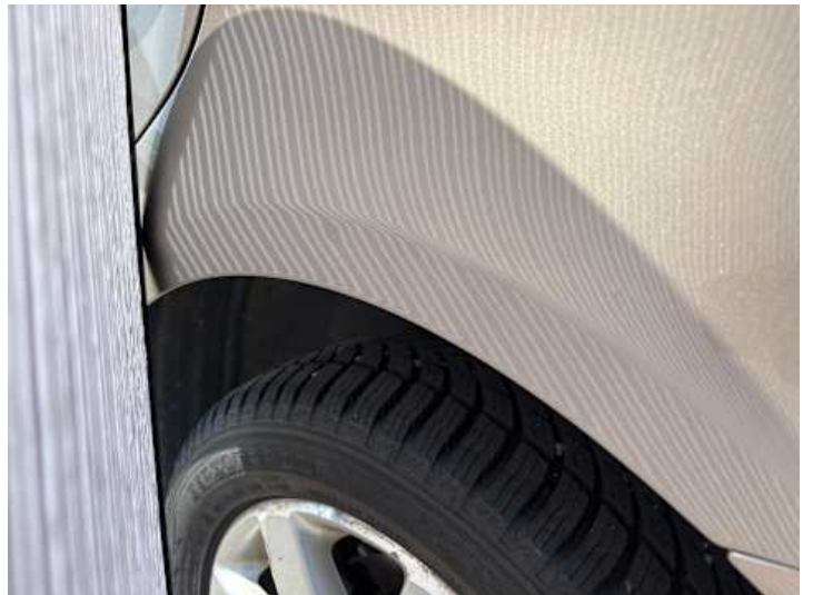
Seitenteil hinten links (Delle)
