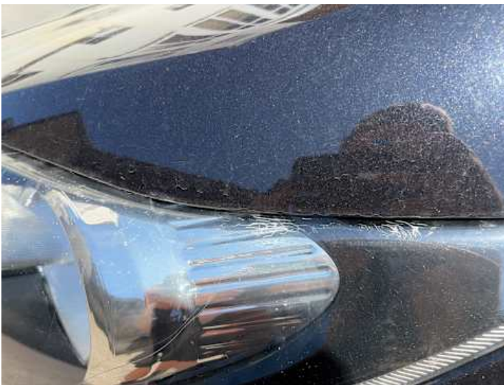
Scheinwerfer (links) (Riss/Bruch)
