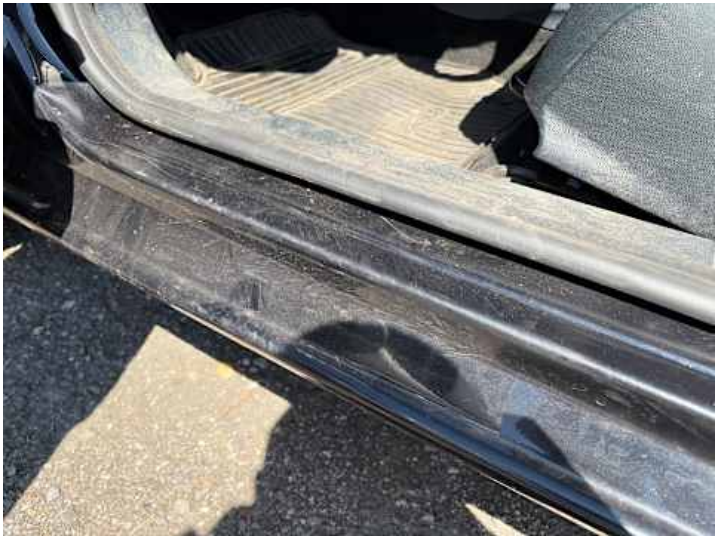
Schweller links (Kratzer)
