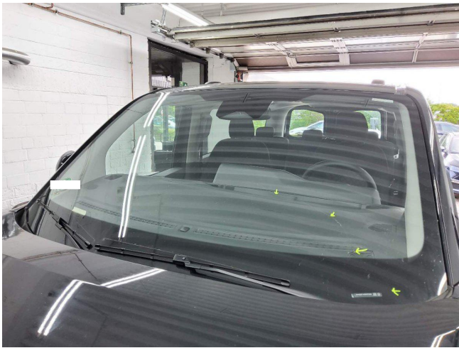
Windschutzscheibe Steinschlag mit Rissbildung (DEKRA)
