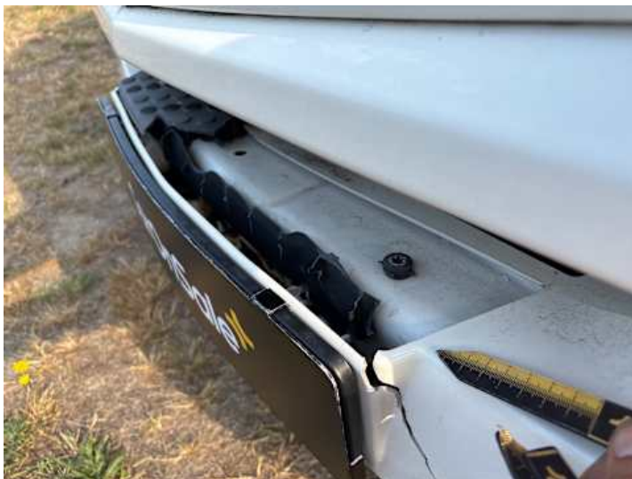
Stoßstange vorne (Riss/Bruch)
