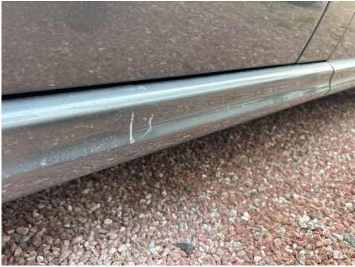
Schweller links (Kratzer)
