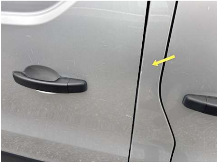
Türe hinten rechts (Kratzer)
