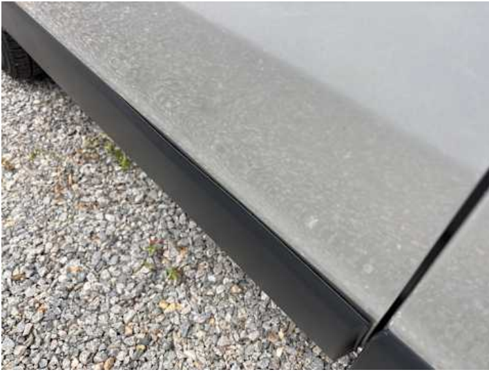
Türe hinten rechts (Spaltmaße ungenau)
