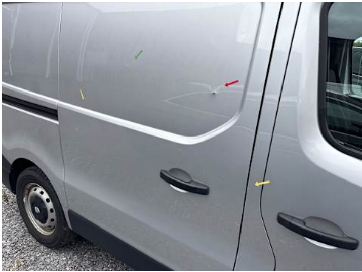
Türe hinten rechts (Kratzer, Lackschaden, Delle)
