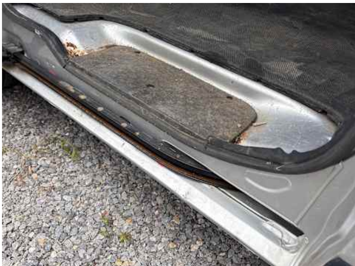
Schweller rechts (Kratzer, Lackschaden, Rost, Delle)
