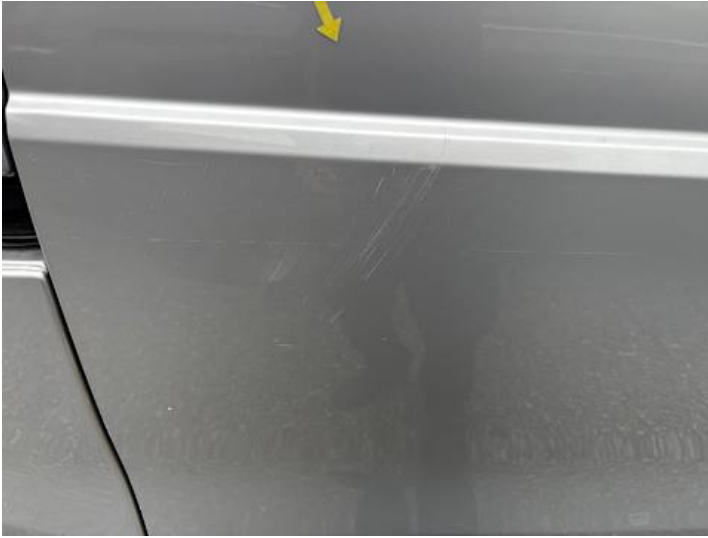
Türe hinten rechts (Kratzer, Delle)
