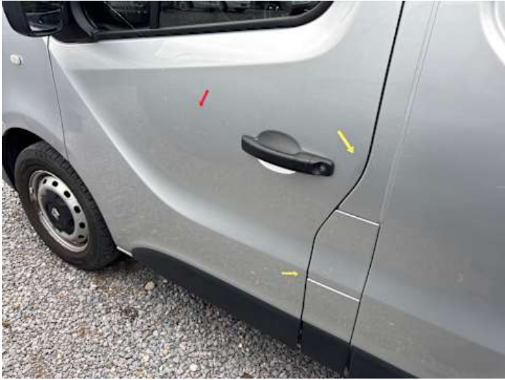
Fahrtür (Delle, Kratzer)
