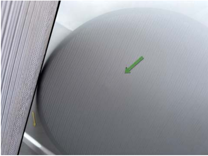
Türe hinten rechts (Delle)
