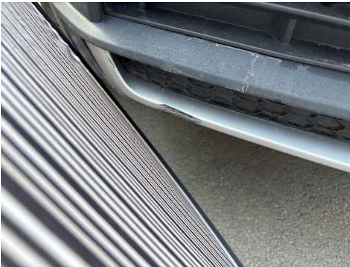
Stoßstange vorne (Delle)
