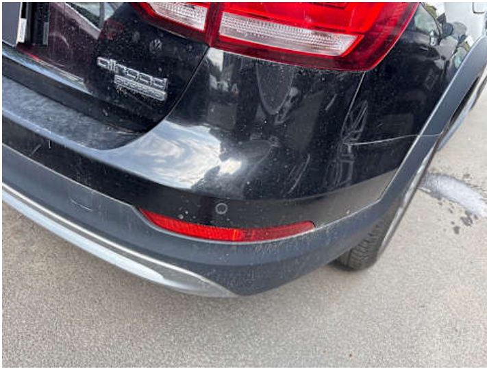
Stoßstange hinten (Kratzer)
