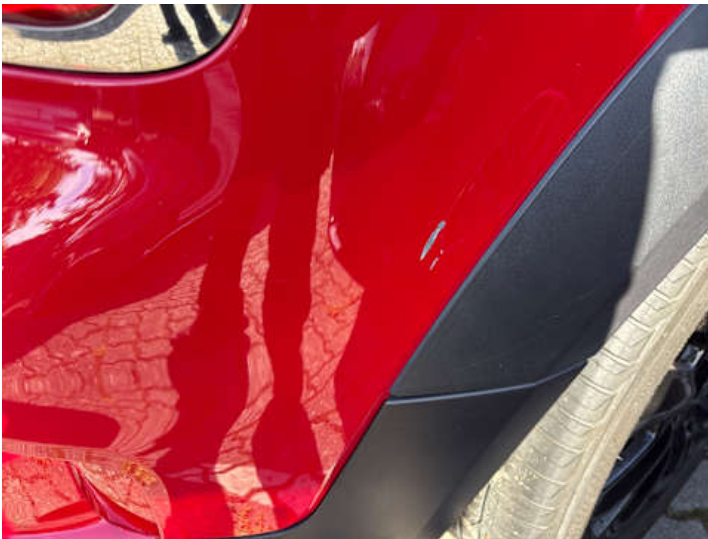
Stoßstange hinten (Lackschaden, Kratzer)
