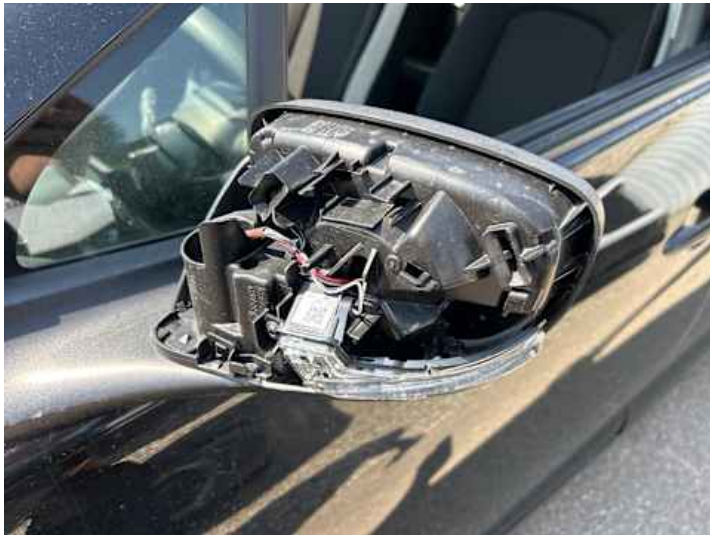
Fahrtür (Anderer Schaden): Abdeckung fehlt
