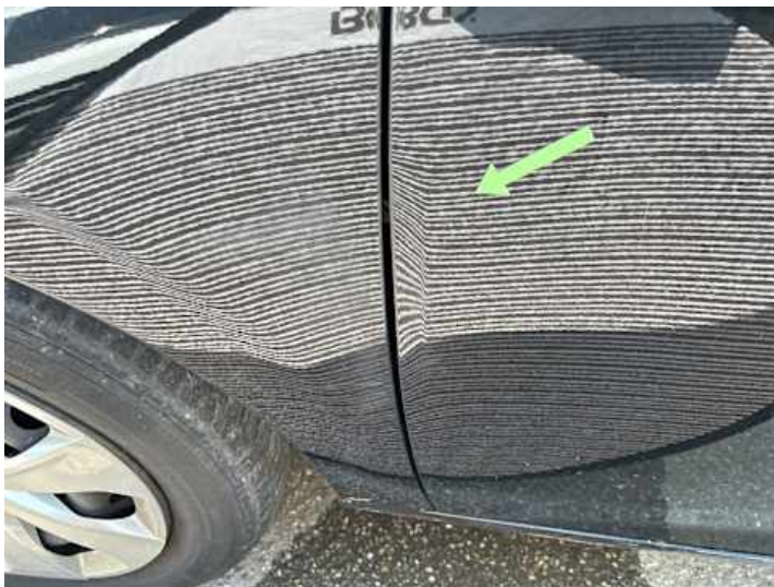
Fahrtür (Delle, Kratzer)
