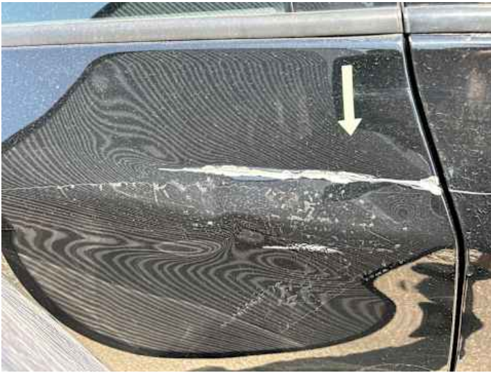
Türe hinten rechts (Kratzer, Verformung)
