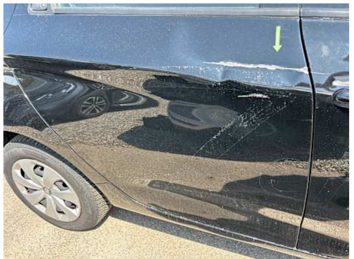
Türe hinten rechts (Kratzer, Verformung)
