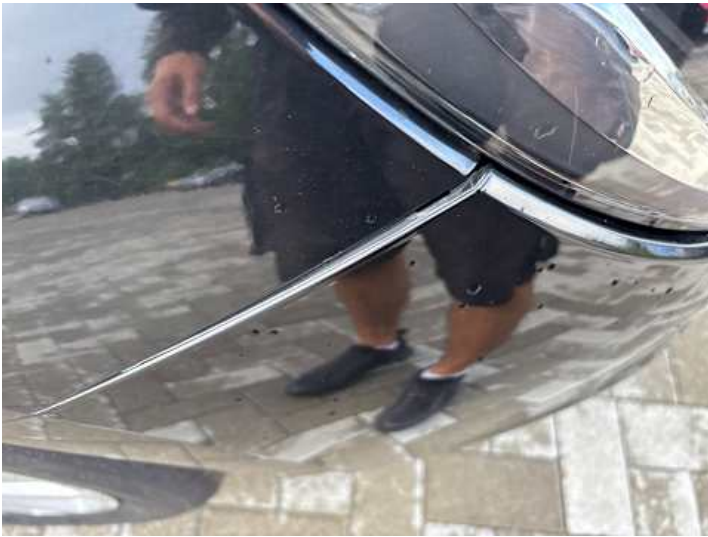
Stoßstange vorne (Spaltmaße ungenau)
