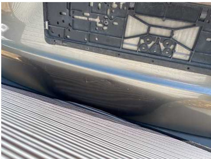
Heckklappe (Verformung, Kratzer)
