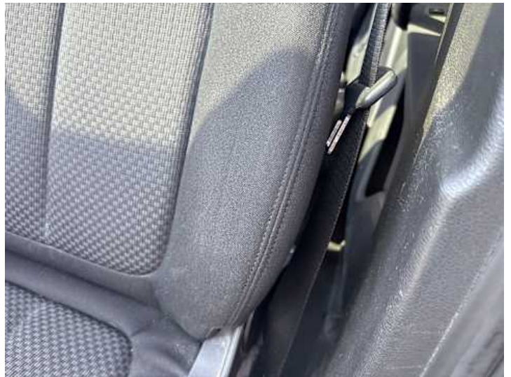
Innenraum (Verschmutzung, Verschleiß)
