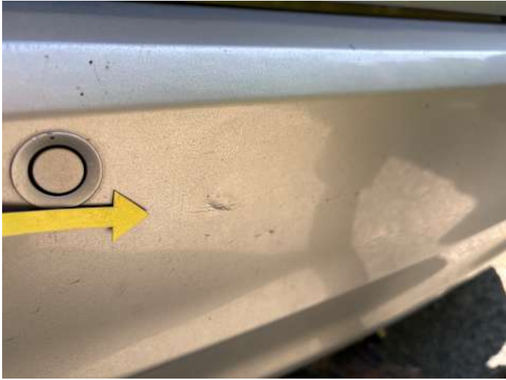
Stoßstange hinten (Lackschaden, Verformung, Riss/Bruch)
