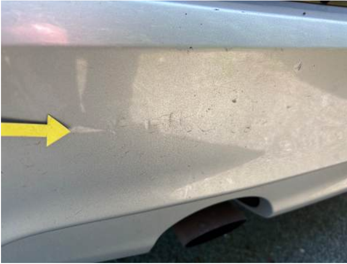
Stoßstange hinten (Lackschaden, Verformung, Riss/Bruch)
