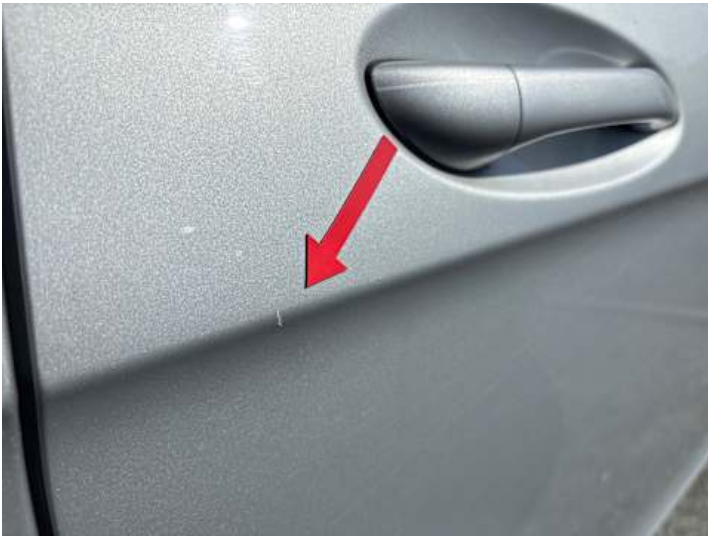
Türe hinten rechts (Kratzer, Lackschaden)
