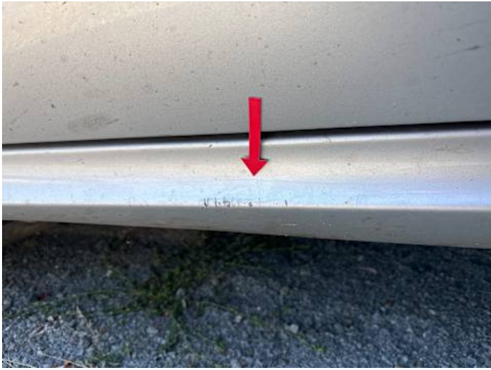
Schweller links (Lackschaden, Kratzer)
