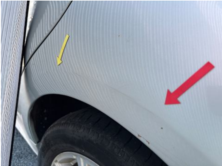
Seitenteil hinten links (Verformung)
