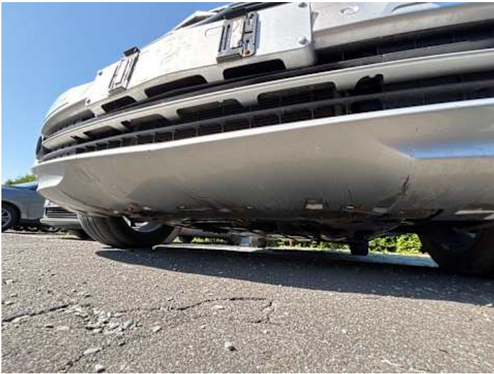
Stoßstange vorne (Kratzer, Lackschaden)
