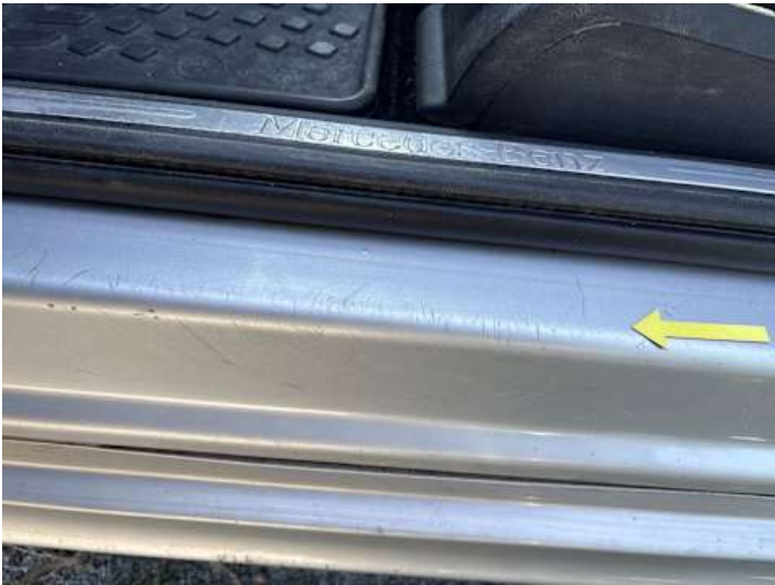
Schweller links (Kratzer)
