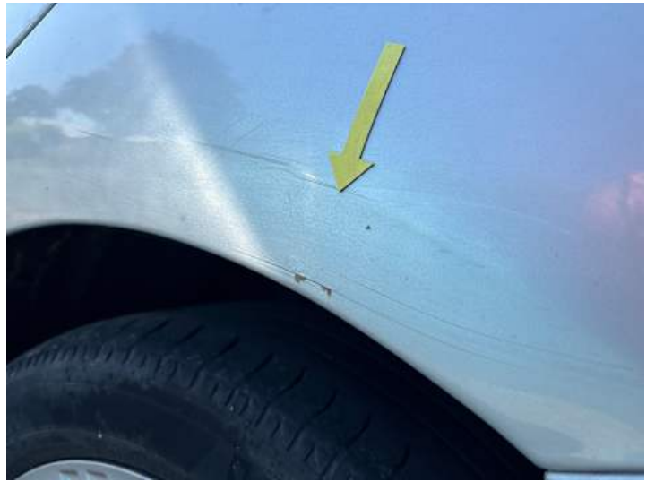
Seitenteil hinten links (Rost, Lackschaden)
