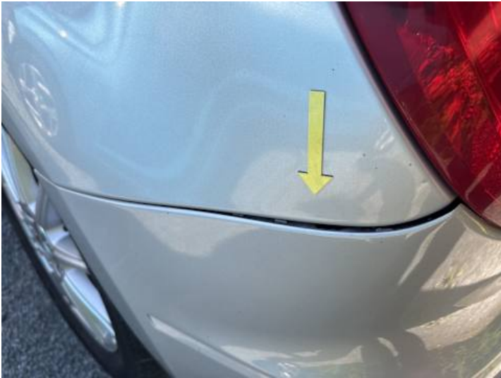
Seitenteil hinten links (Spaltmaße ungenau)
