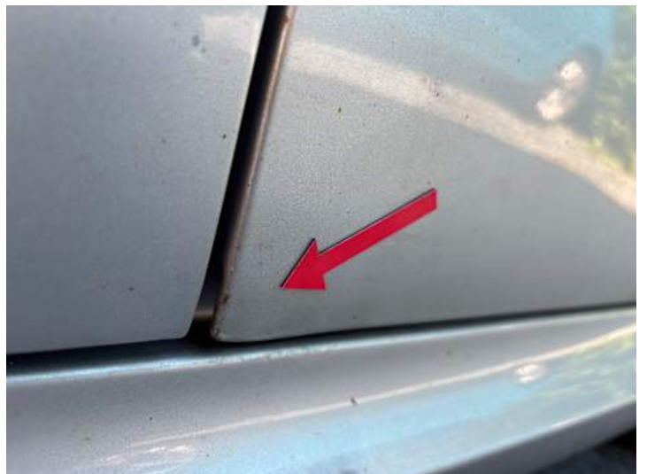
Türe hinten links (Rost)
