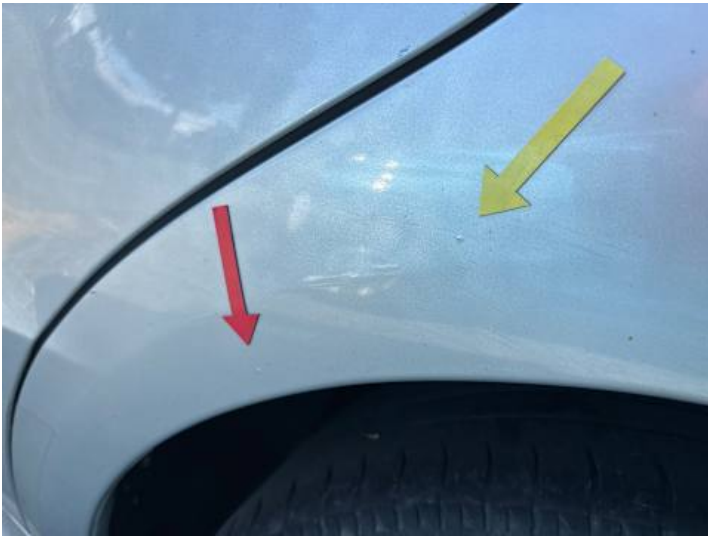
Seitenteil hinten links (Rost, Lackschaden)
