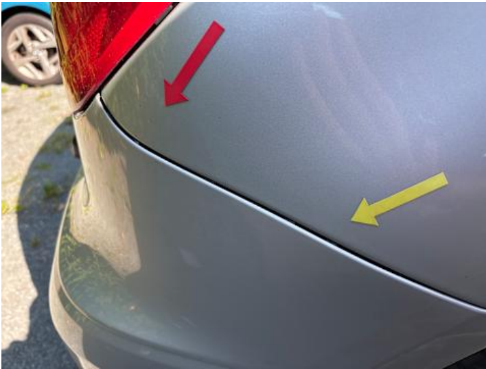
Seitenteil hinten rechts (Spaltmaße ungenau)
