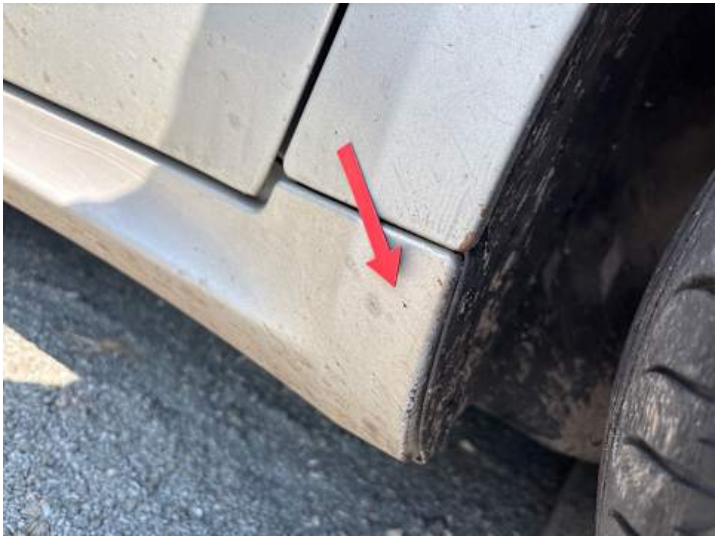
Schweller rechts (Rost)
