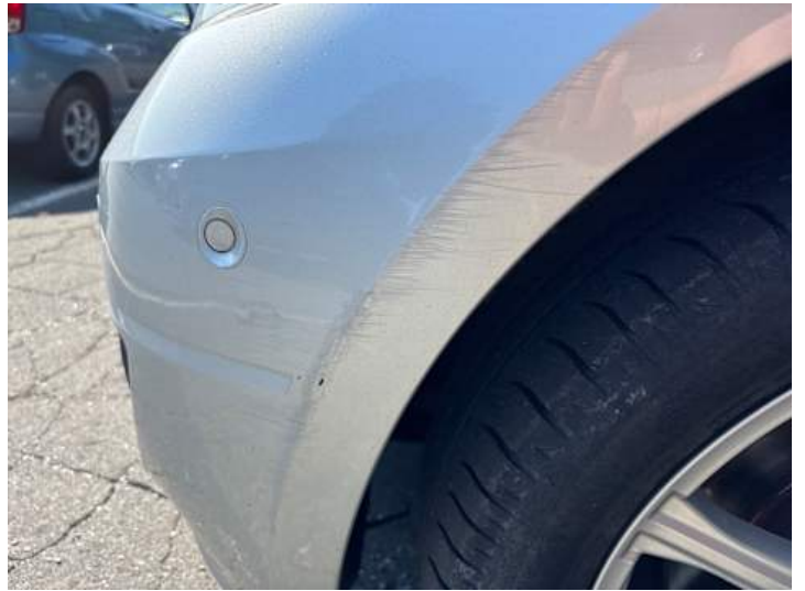
Stoßstange vorne (Kratzer, Lackschaden)
