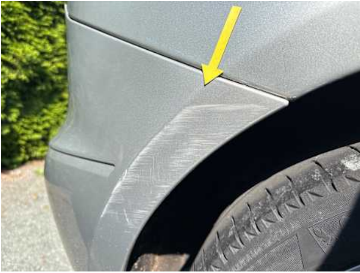
Stoßstange hinten (Lackschaden, Kratzer)
