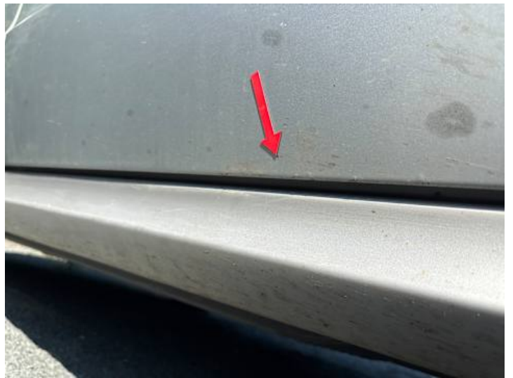
Beifahrertür (Lackschaden, Rost)
