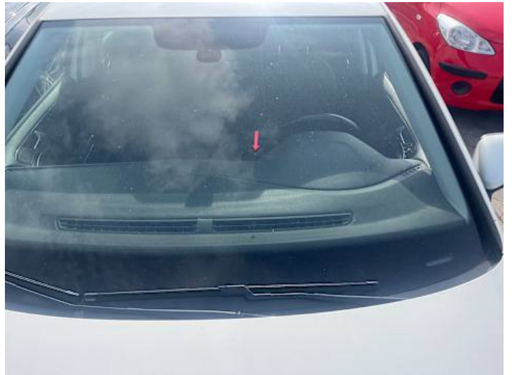
Windschutzscheibe (Steinschlag, Riss/Bruch)
