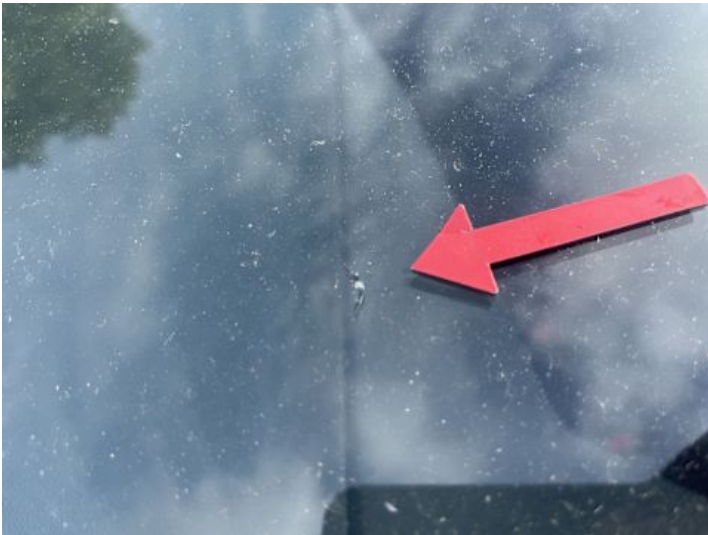
Windschutzscheibe (Steinschlag, Riss/Bruch)
