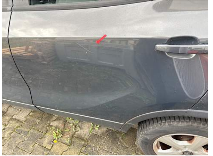
Türe hinten links (Kratzer)
