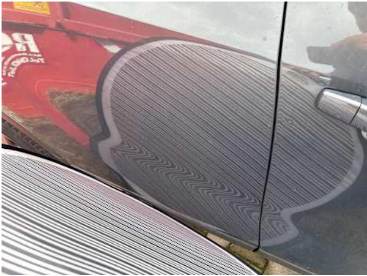
Türe hinten rechts (Delle)
