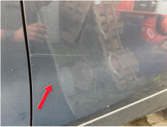
Türe hinten links (Kratzer)
