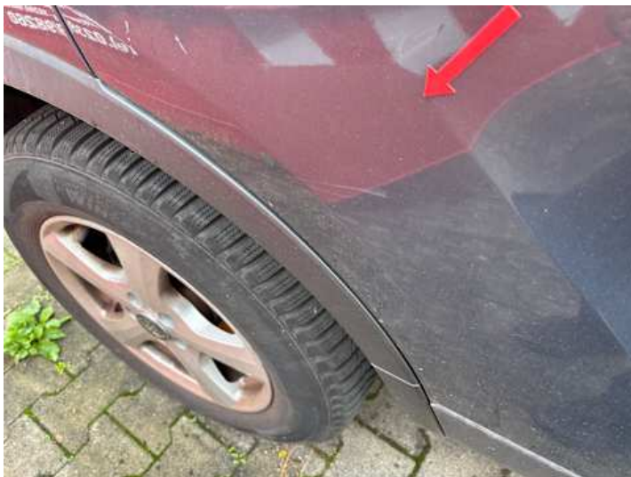
Türe hinten rechts (Kratzer)
