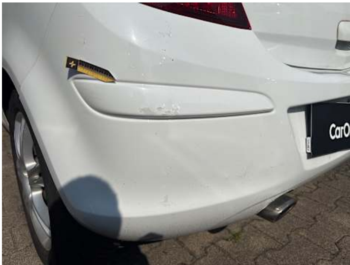
Stoßstange hinten (Verformung, Lackschaden)
