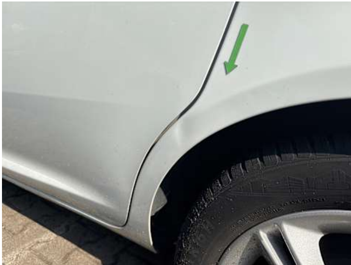
Seitenteil hinten links (Delle)
