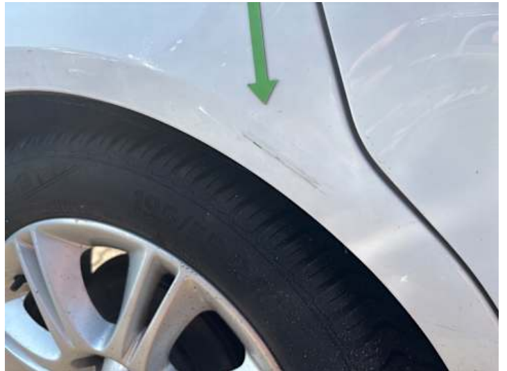
Seitenteil hinten rechts (Kratzer, Delle)
