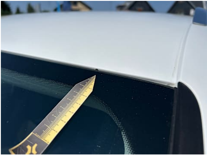
Dach (Steinschlag, Rost)
