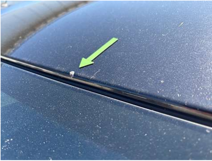
Dach (Lackschaden, Steinschlag, Rost)
