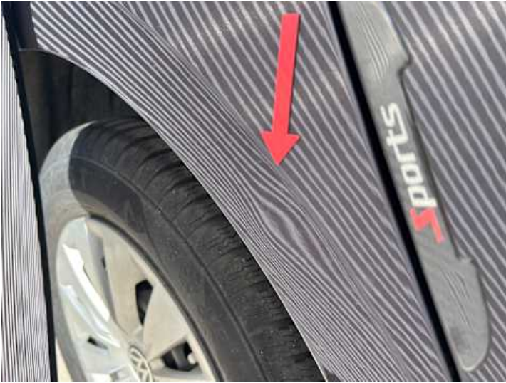
Seitenteil hinten rechts (Delle)
