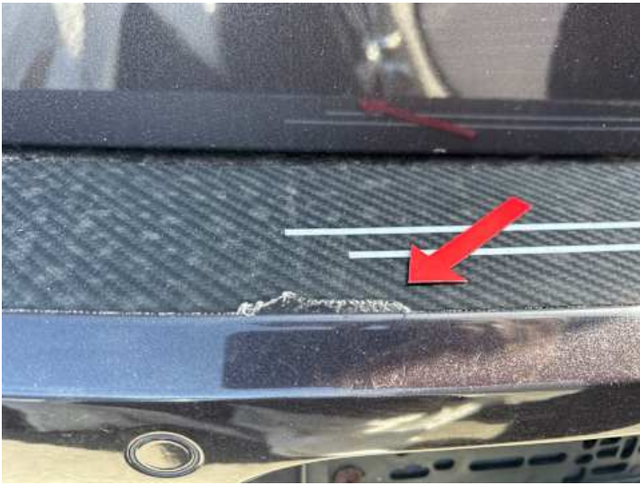
Stoßstange hinten (Lackschaden)
