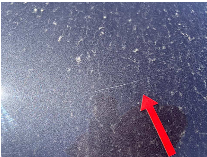
Motorhaube (Lackschaden, Kratzer)
