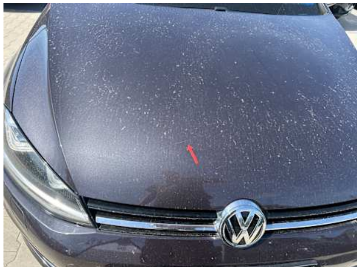
Motorhaube (Lackschaden, Kratzer)
