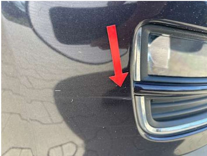
Stoßstange vorne (Kratzer, Lackschaden)
