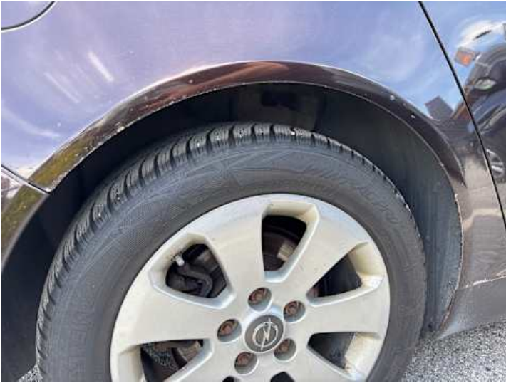
Seitenteil hinten rechts (Steinschlag, Rost, Lackschaden)
