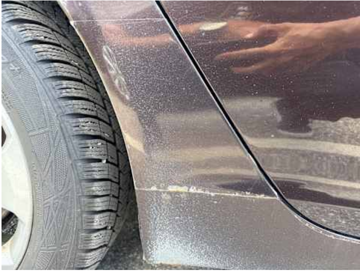
Seitenteil hinten rechts (Steinschlag, Rost, Lackschaden)
