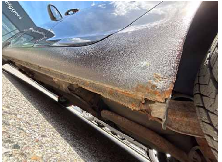
Schweller links (Rost)
