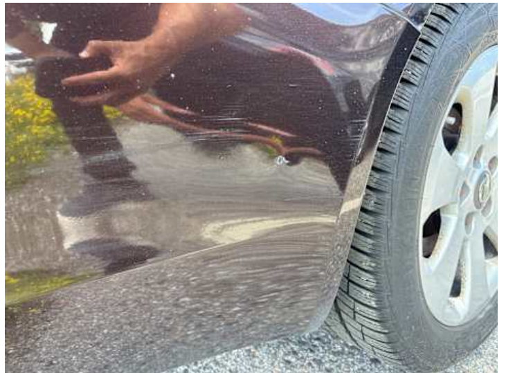
Stoßstange hinten (Verformung, Lackschaden, Kratzer)
