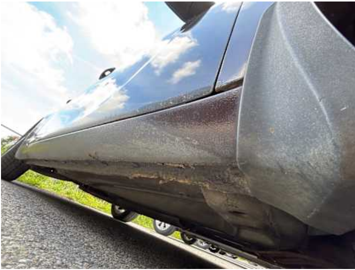
Schweller rechts (Rost)
