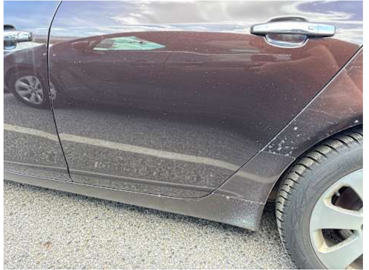
Türe hinten links (Steinschlag)
