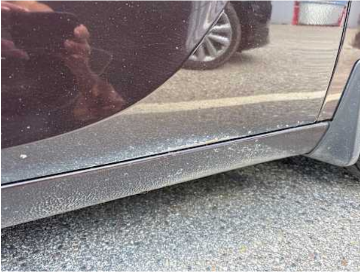
Beifahrertür (Steinschlag, Lackschaden, Rost)
