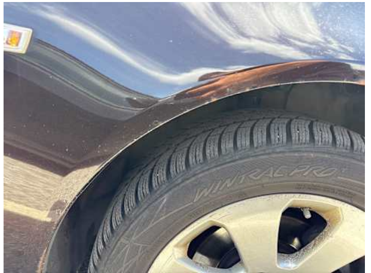
Kotflügel vorne rechts (Rost)
