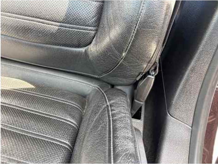
Innenraum (Verschleiß, Riss/Bruch)
