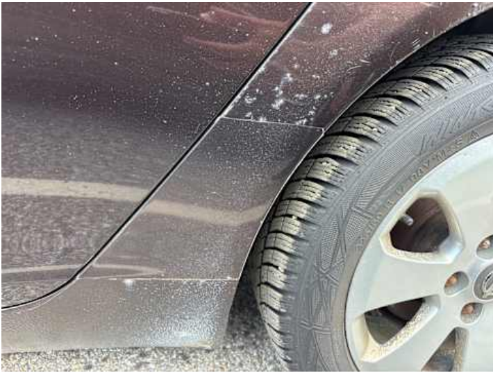
Seitenteil hinten links (Rost, Lackschaden, Steinschlag)
