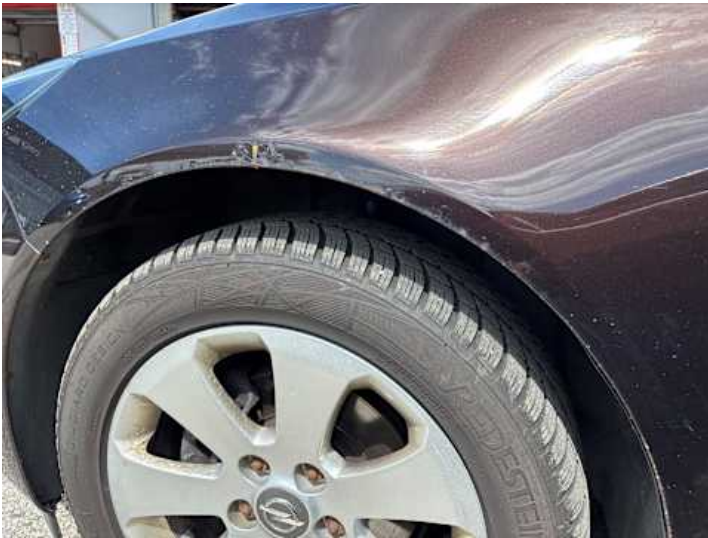
Kotflügel vorne links (Rost)
