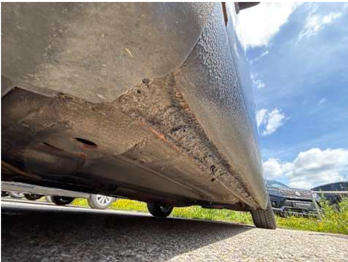
Schweller links (Rost)
