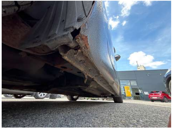
Schweller rechts (Rost)
