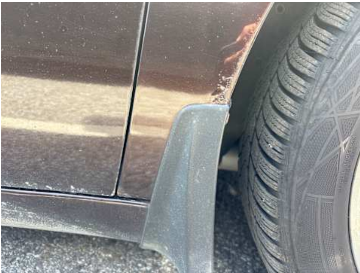
Kotflügel vorne rechts (Rost)
