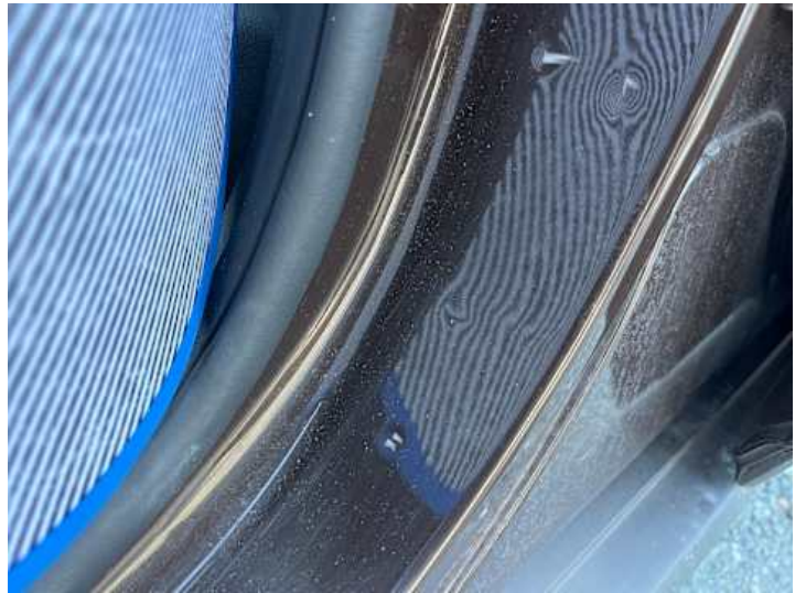
Schweller links (Lackschaden, Delle)
