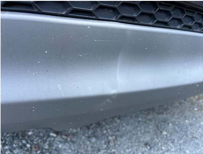
Stoßstange hinten (Anderer Schaden): Gestaut
