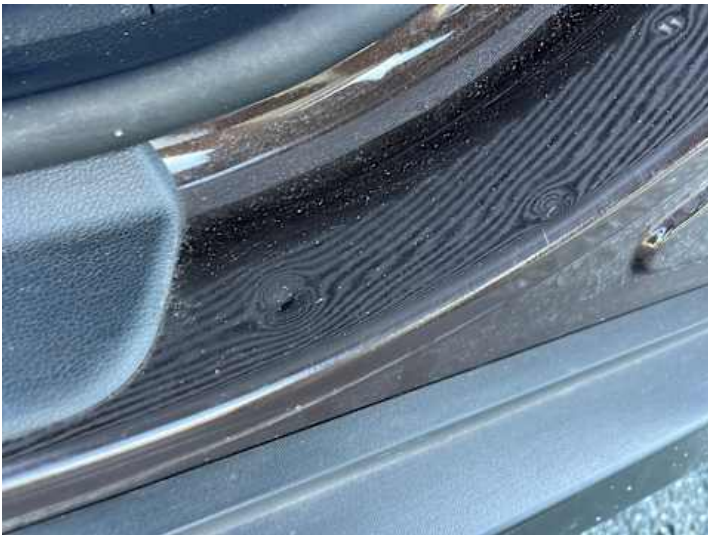
Schweller links (Lackschaden, Delle)
