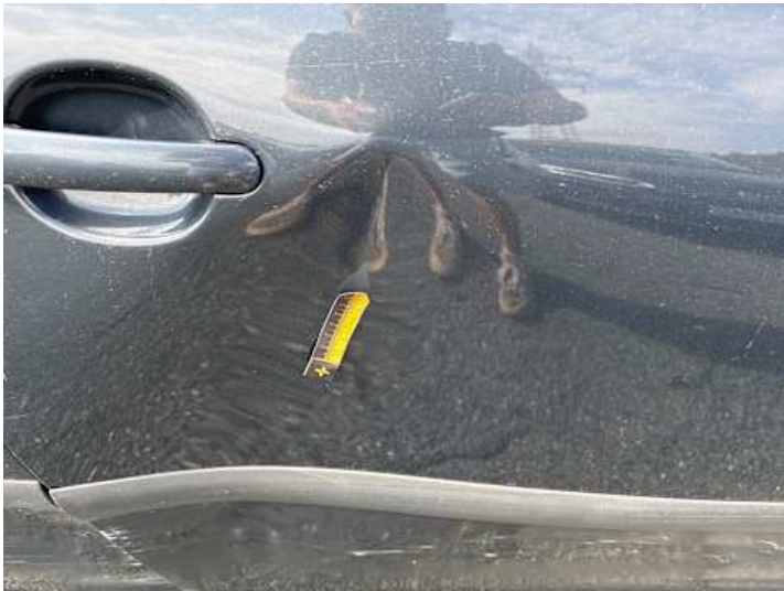
Beifahrtür (Verformung, Kratzer, Rost)
