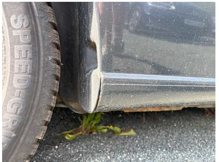
Schweller rechts (Rost)
