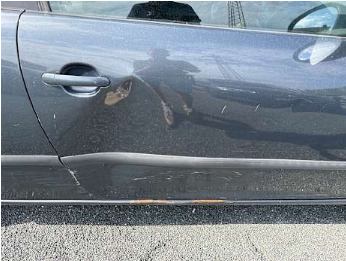
Beifahrtür (Verformung, Kratzer, Rost)
