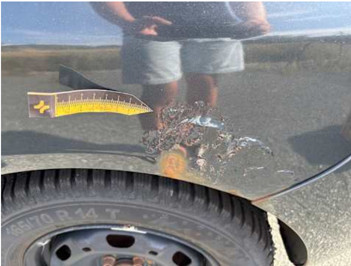
Seitenteil hinten links (Rost)
