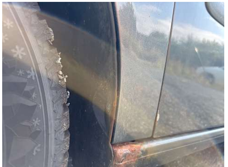
Kotflügel vorne links (Rost)
