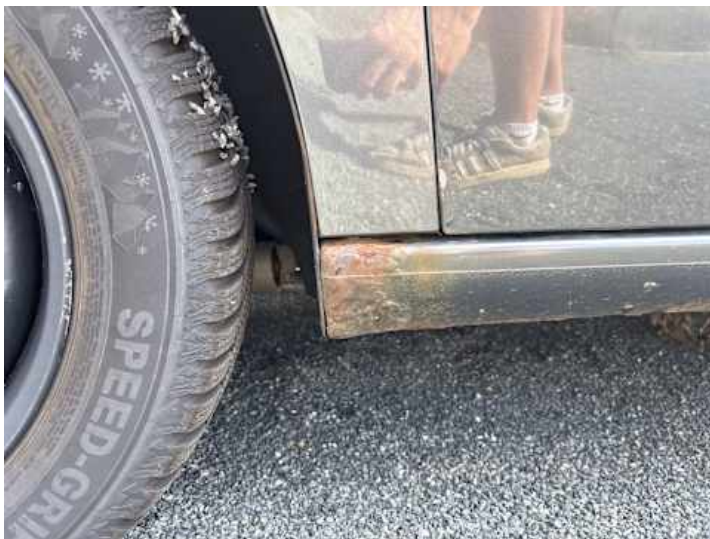
Schweller links (Rost)
