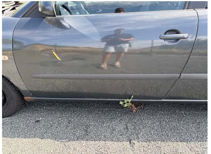
Fahrtür (Delle, Kratzer, Unsachgemäß instand gesetzt)
