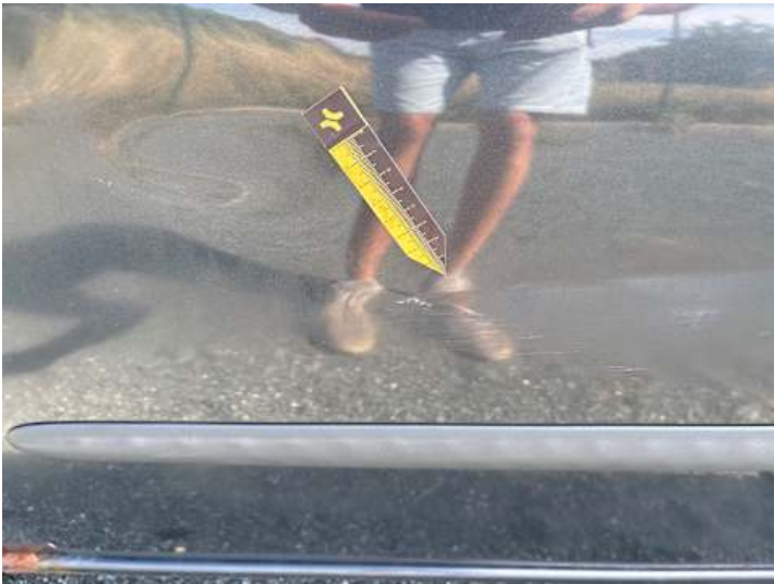
Fahrtür (Delle, Kratzer, Unsachgemäß instand gesetzt)
