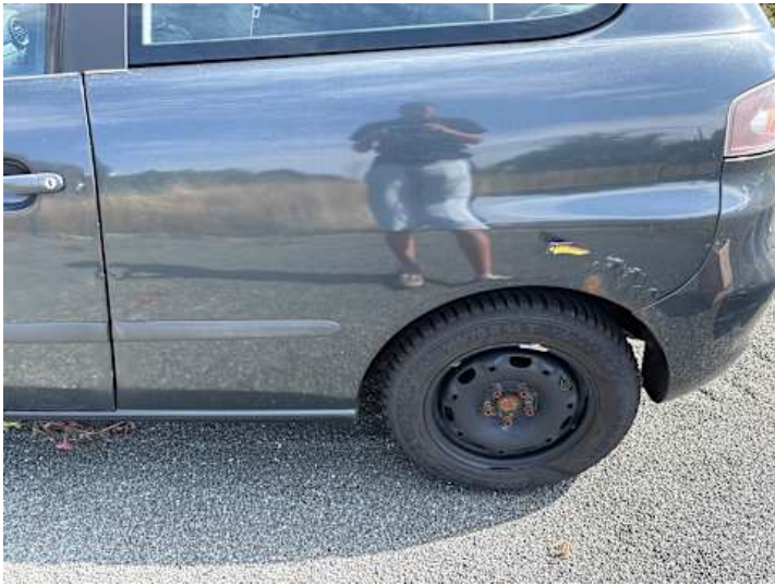
Seitenteil hinten links (Rost)
