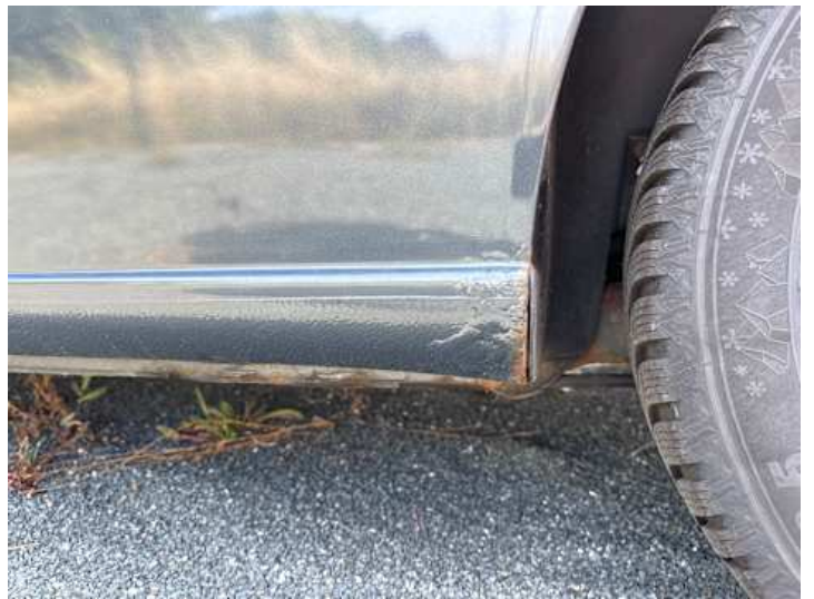
Schweller links (Rost)
