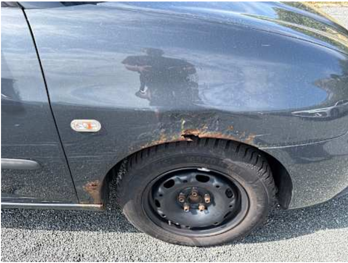
Kotflügel vorne rechts (Rost)
