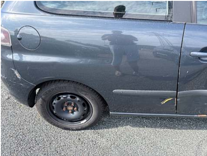
Seitenteil hinten rechts (Rost, Verformung, Kratzer)
