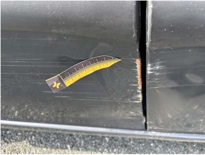
Seitenteil hinten rechts (Rost, Verformung, Kratzer)
