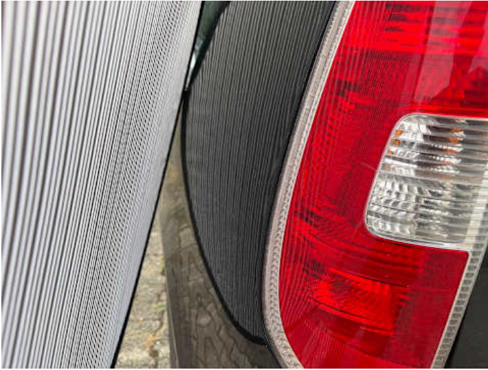
Seitenteil hinten links (Delle)
