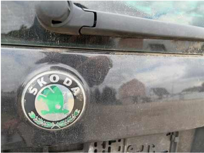
Heckklappe (Lackschaden, Kratzer)
