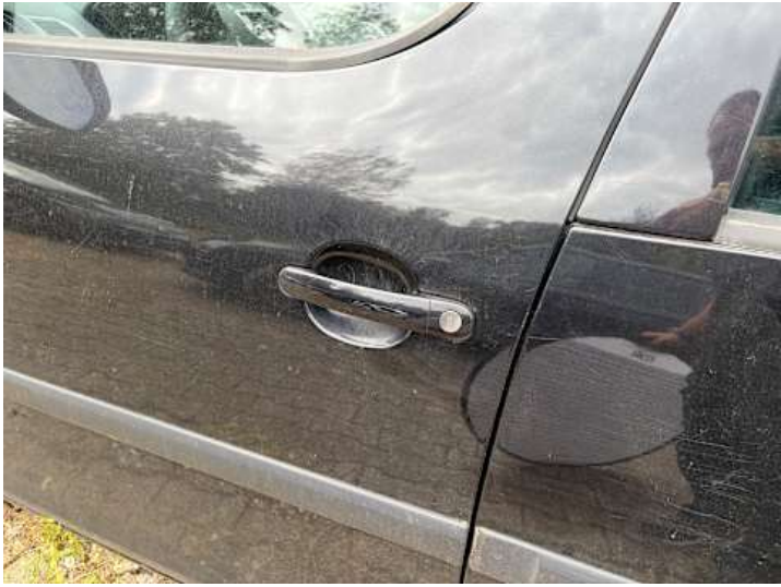
Fahrtür (Lackschaden, Kratzer)
