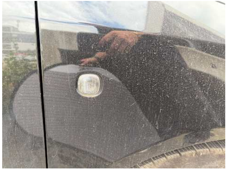
Kotflügel vorne rechts (Lackschaden, Kratzer)
