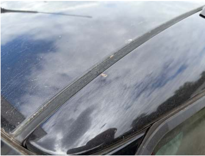
Dach (Lackschaden, Kratzer, Steinschlag)
