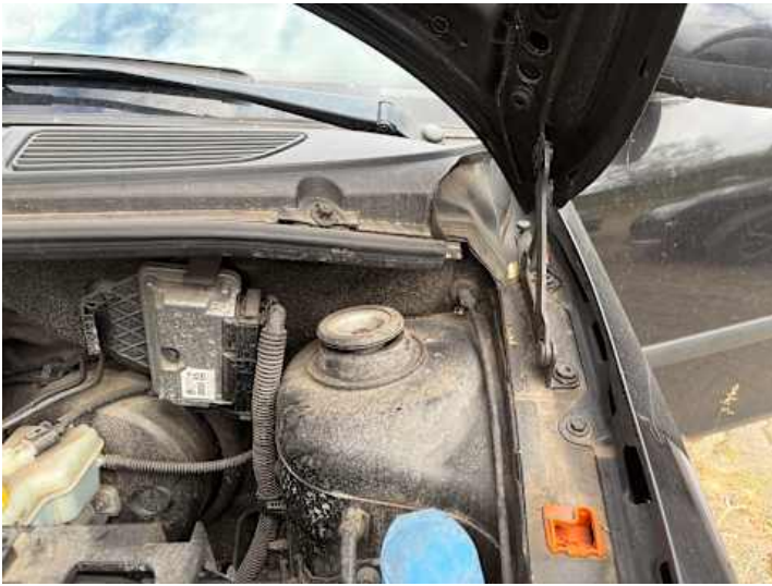
Motorhaube (Riss/Bruch, Anderer Schaden): Motorhauben Halter fehlt
