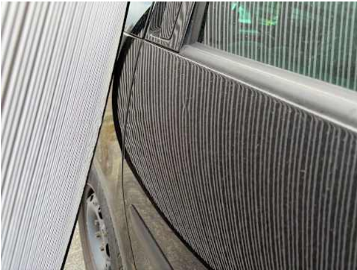
Türe hinten rechts (Delle)
