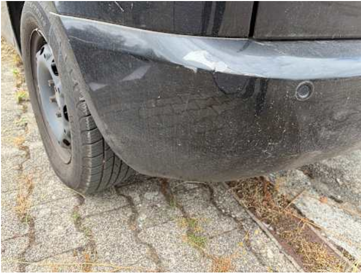
Stoßstange hinten (Lackschaden, Kratzer, Riss/Bruch)
