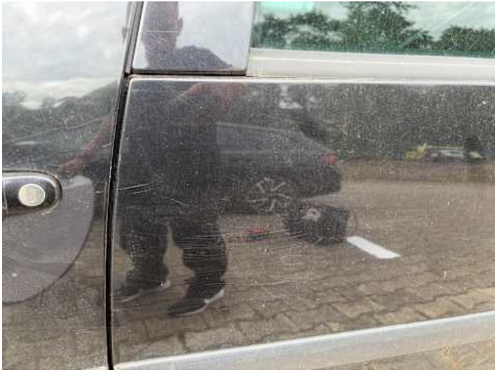
Türe hinten links (Lackschaden, Kratzer)
