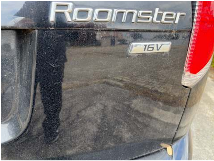
Heckklappe (Lackschaden, Kratzer)
