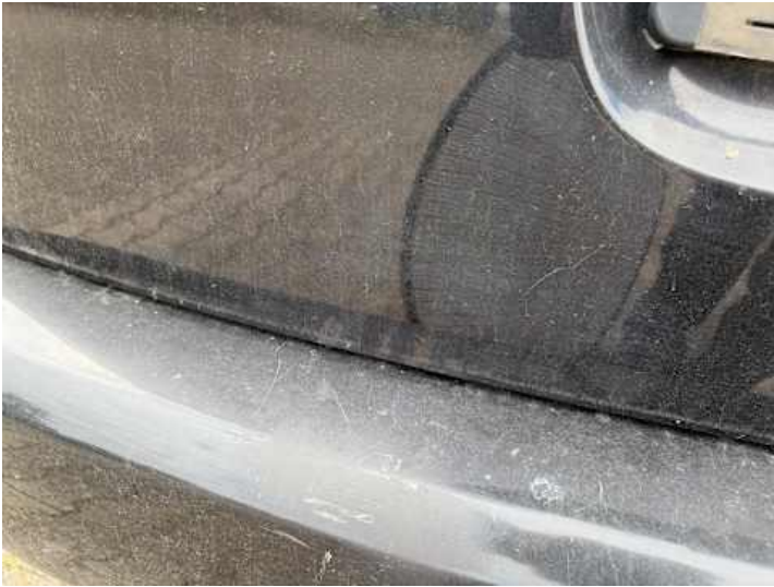
Heckklappe (Lackschaden, Kratzer)
