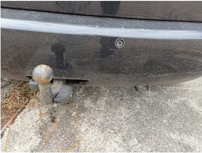
Stoßstange hinten (Lackschaden, Kratzer)
