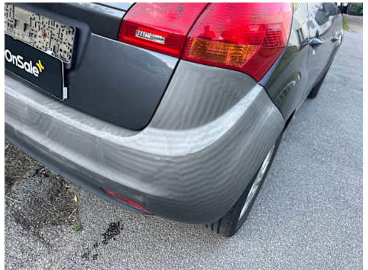
Stoßstange hinten (Unsachgemäß instand gesetzt)
