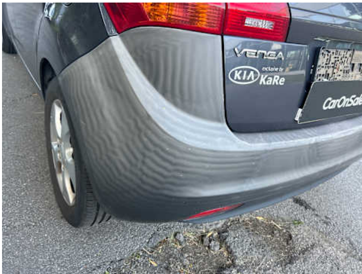
Stoßstange hinten (Unsachgemäß instand gesetzt)
