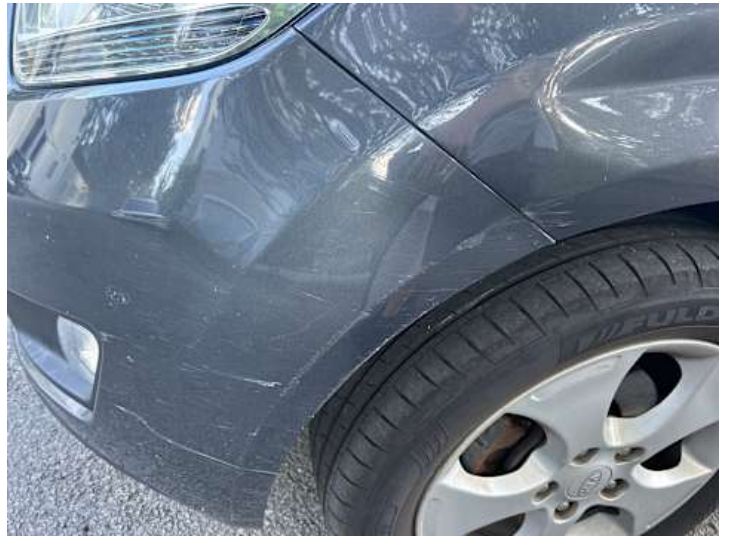
Stoßstange vorne (Kratzer, Lackschaden)
