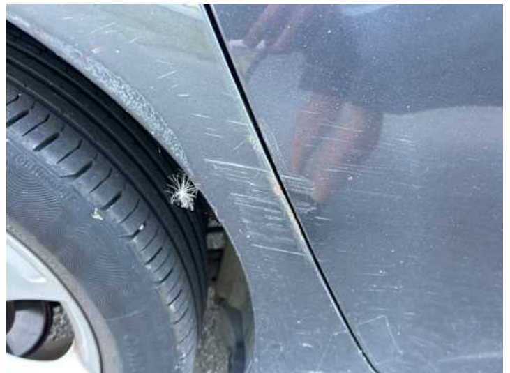
Seitenteil hinten rechts (Delle, Kratzer, Rost)
