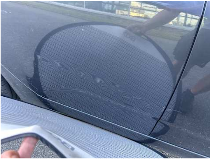
Türe hinten rechts (Delle, Kratzer)
