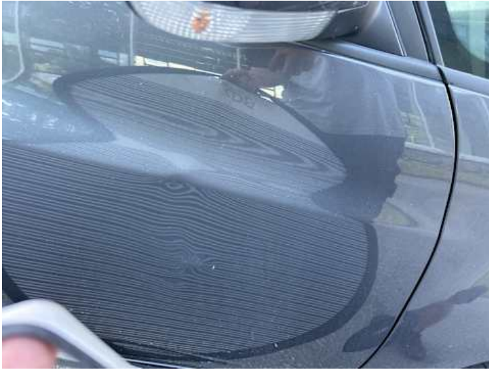
Beifahrertür (Delle, Kratzer)
