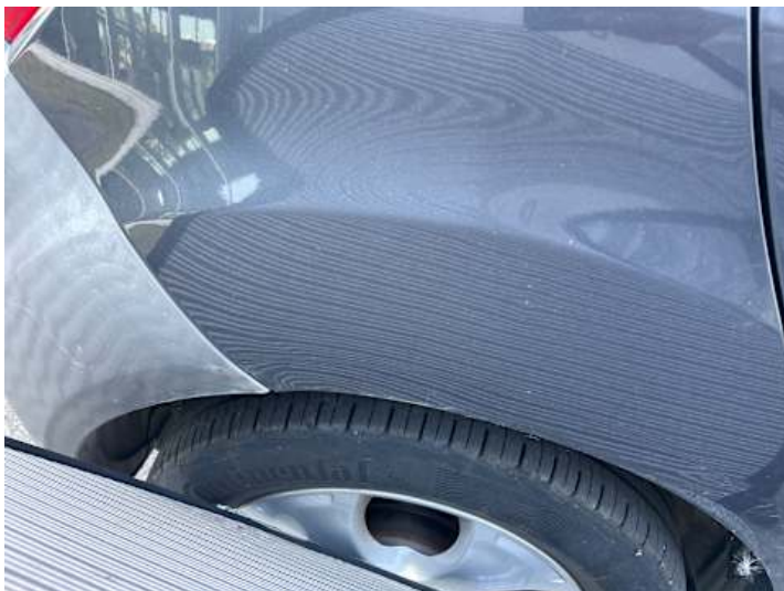
Seitenteil hinten rechts (Delle, Kratzer, Rost)
