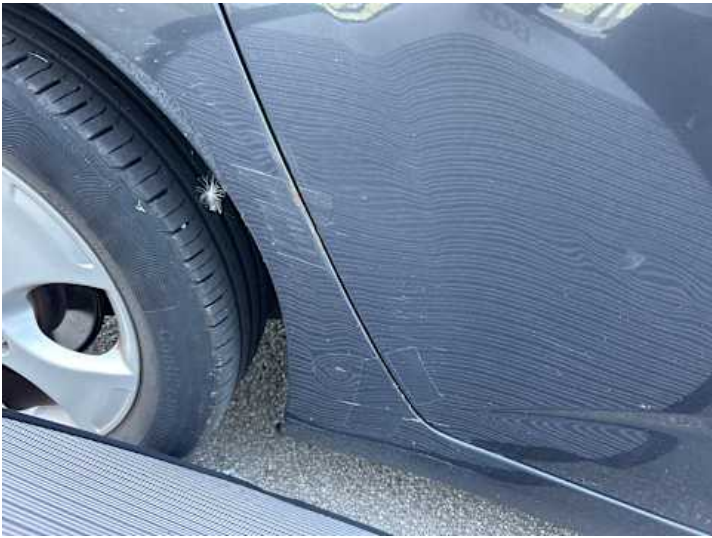
Seitenteil hinten rechts (Delle, Kratzer, Rost)
