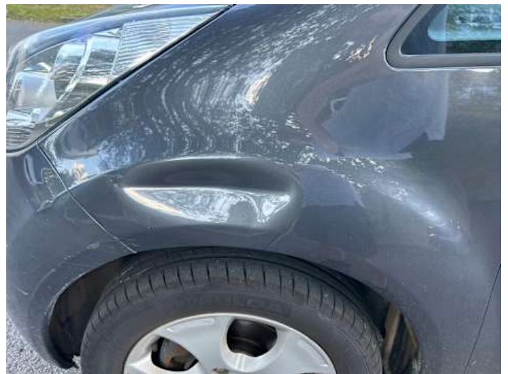
Kotflügel vorne links (Verformung, Kratzer)
