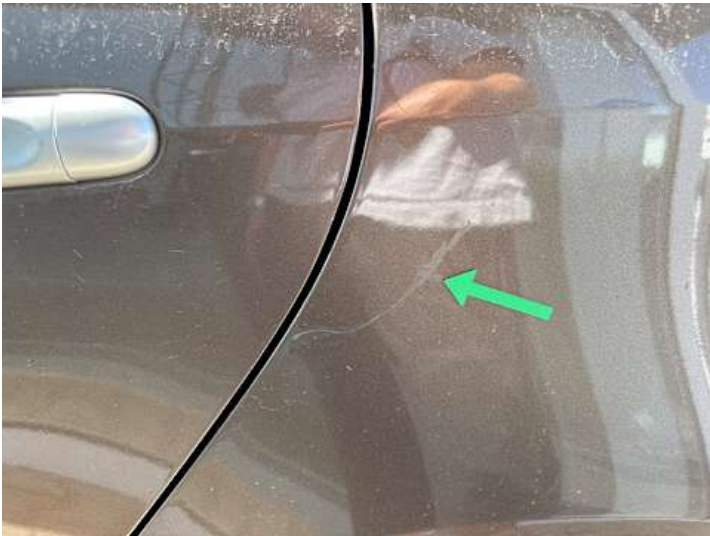
Seitenteil hinten links (Unsachgemäß instand gesetzt, Lackschaden, Kratzer)
