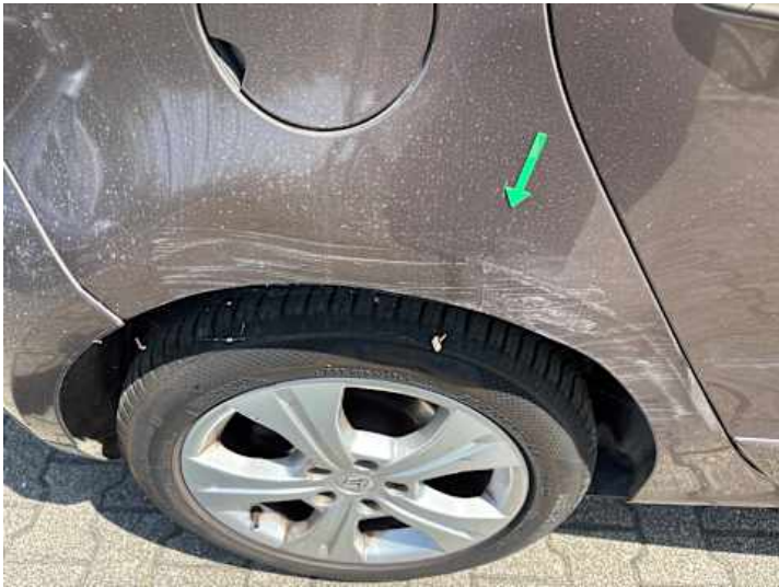
Seitenteil hinten rechts (Kratzer, Verformung, Delle, Unsachgemäß instand gesetzt)
