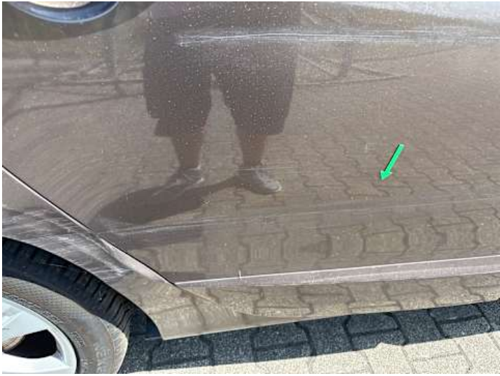
Türe hinten rechts (Kratzer, Verformung)
