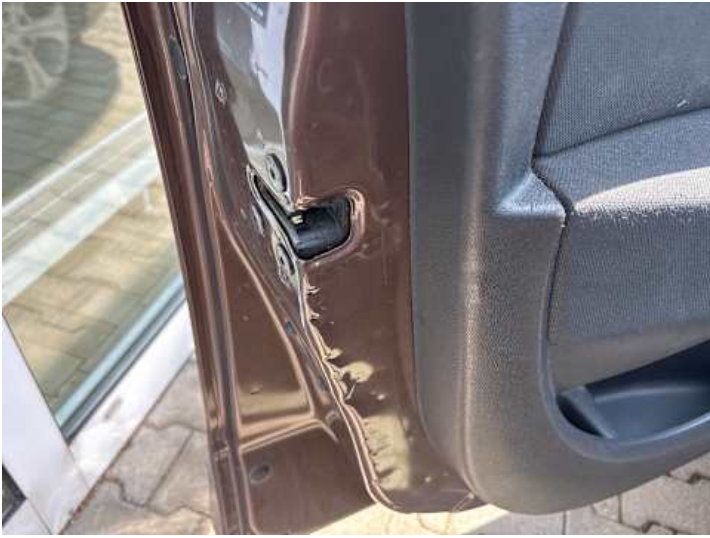
Fahrtür (Delle, Kratzer)
