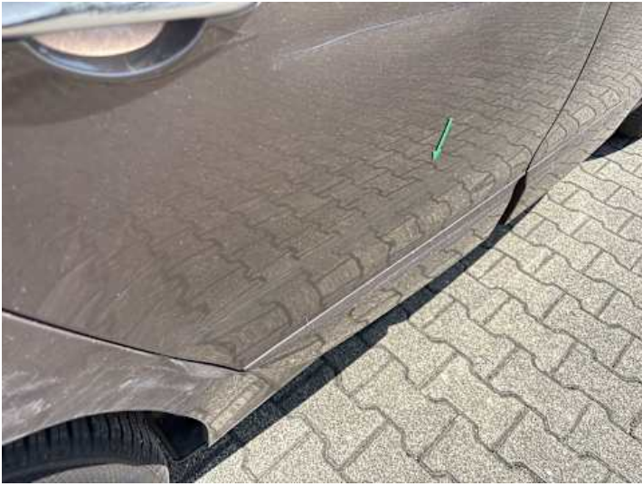
Türe hinten rechts (Kratzer, Verformung)
