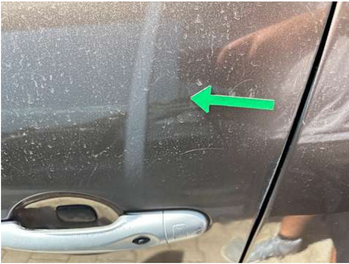
Fahrtür (Delle, Kratzer)
