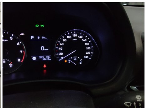
Warnleuchte Kraftstoff / Zu wenig
