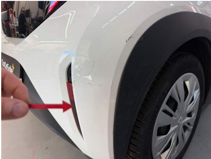
Stoßstange hinten (Kratzer)
