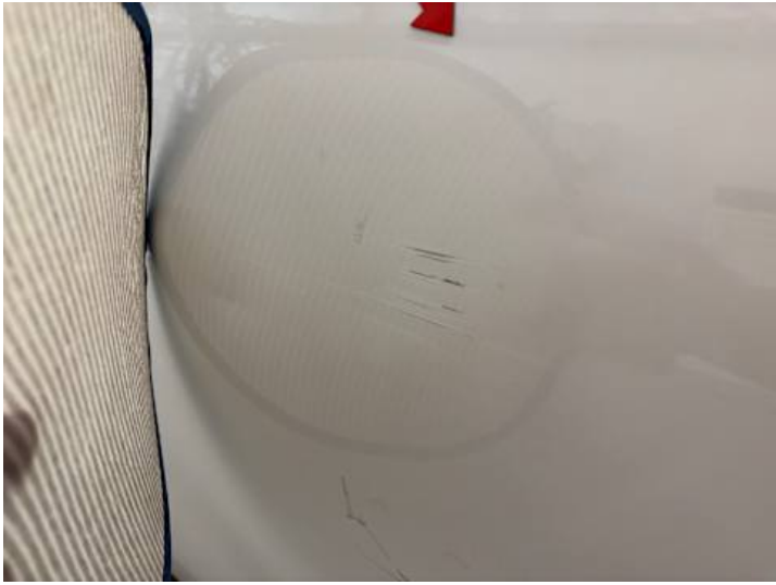
Beifahrtür (Verformung, Kratzer)
