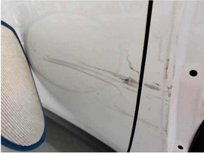
Beifahrtür (Verformung, Kratzer)
