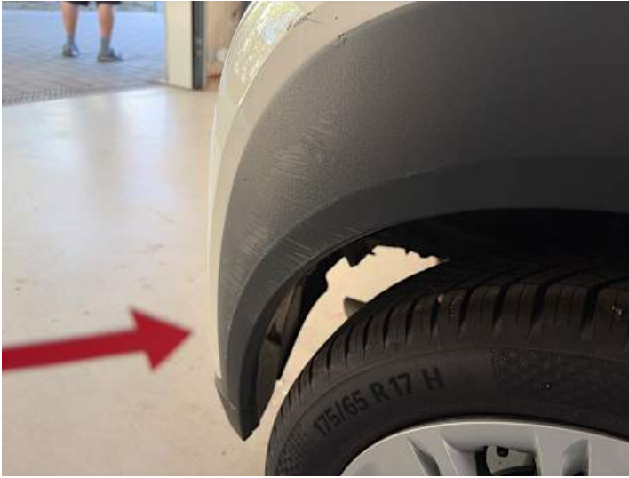
Seitenteil hinten rechts (Kratzer)
