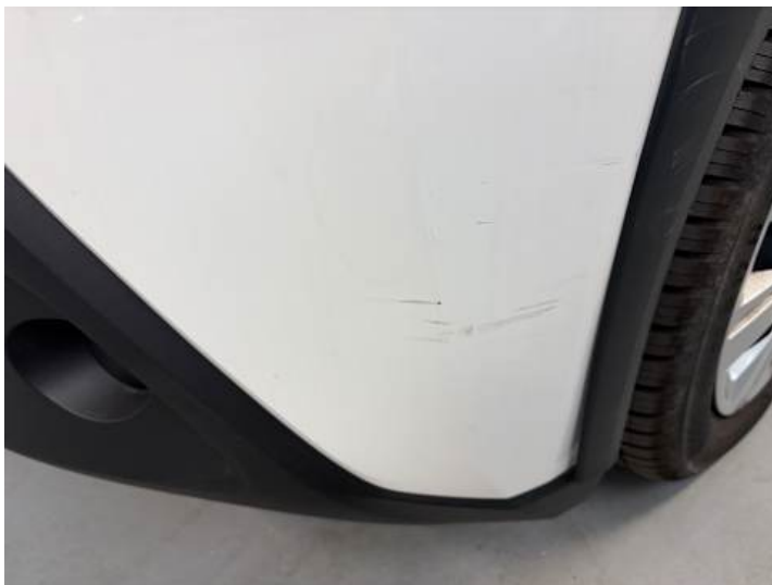
Stoßstange vorne (Kratzer, Riss/Bruch)
