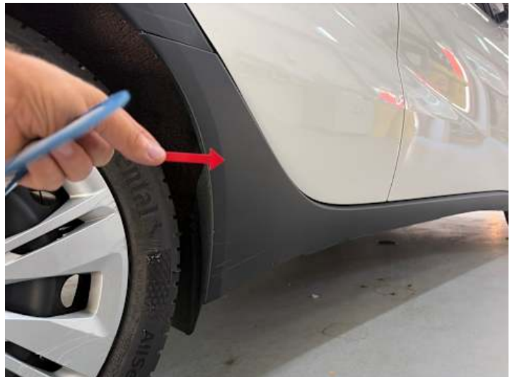
Schweller rechts (Kratzer)
