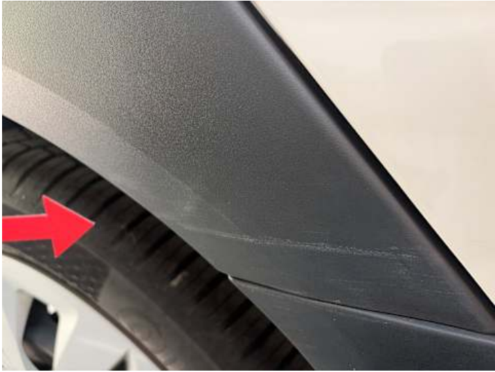
Seitenteil hinten rechts (Kratzer)
