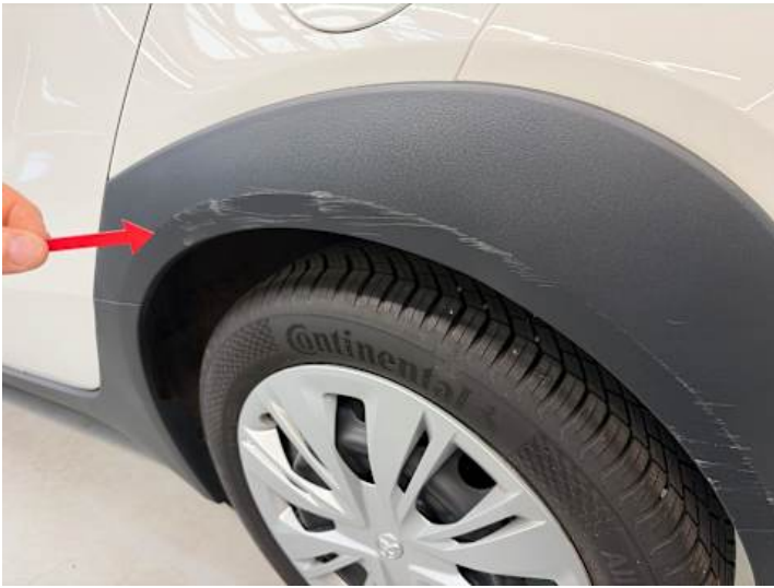
Seitenteil hinten links (Kratzer)
