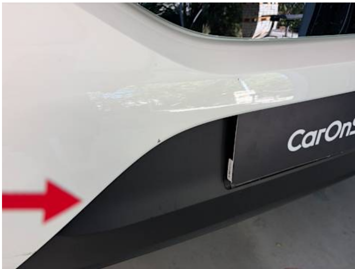
Stoßstange hinten (Kratzer)
