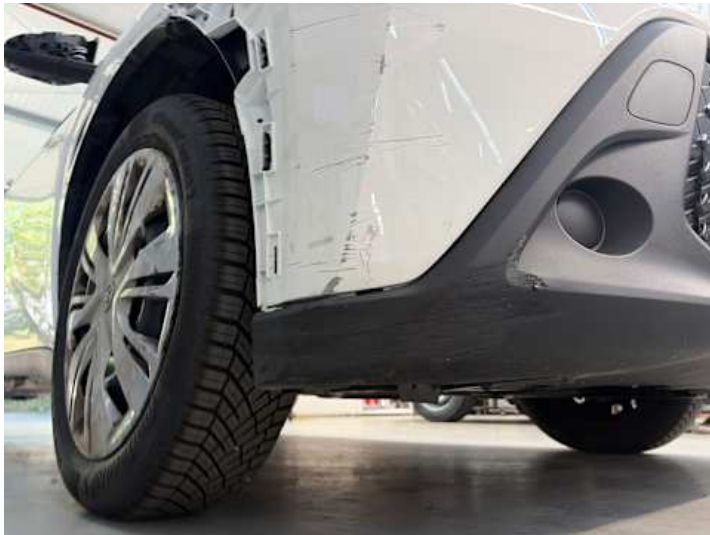
Stoßstange vorne (Kratzer, Riss/Bruch)
