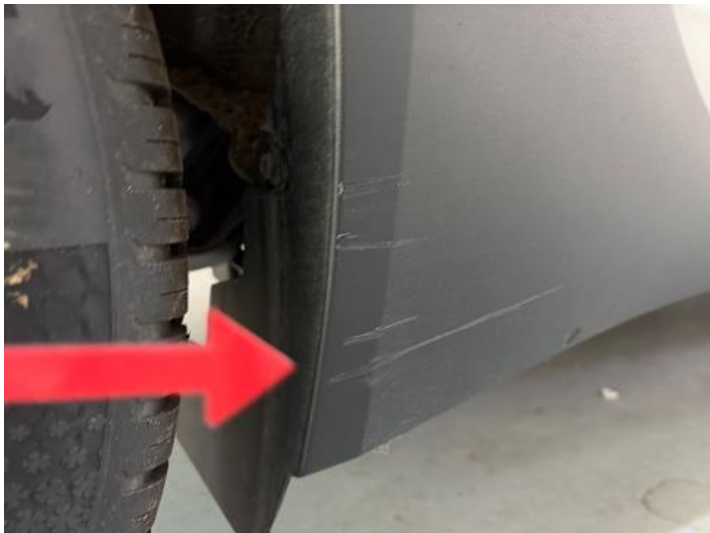
Schweller rechts (Kratzer)
