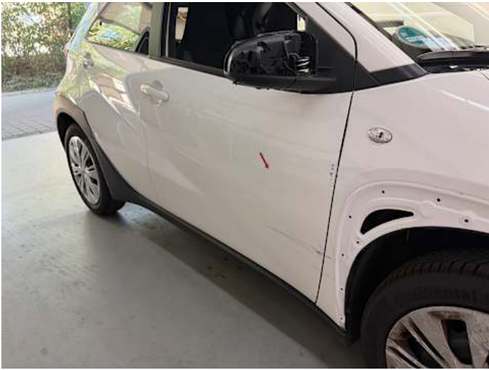
Beifahrertür (Verformung, Kratzer)
