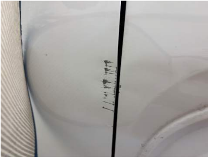
Beifahrtür (Verformung, Kratzer)
