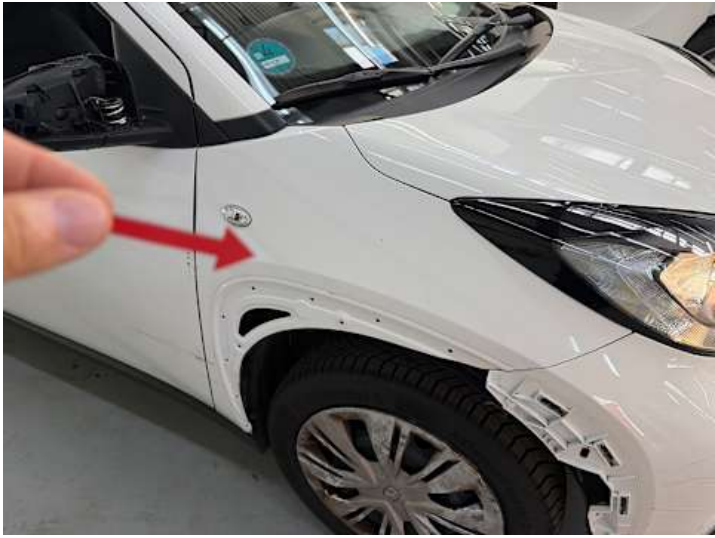
Kotflügel vorne rechts (Riss/Bruch, Kratzer)
