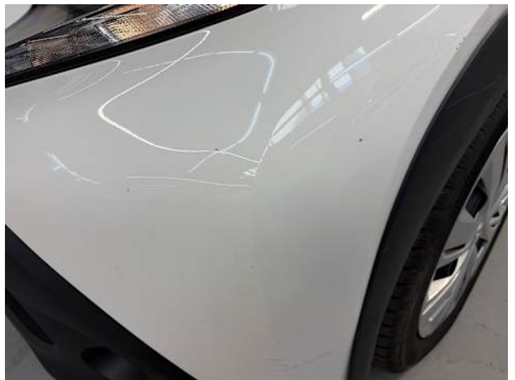
Stoßstange vorne (Kratzer, Riss/Bruch)
