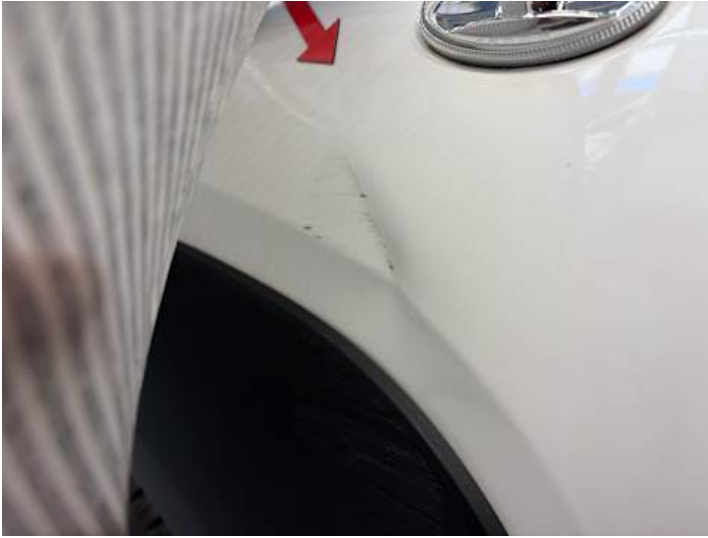
Kotflügel vorne links (Kratzer, Delle)
