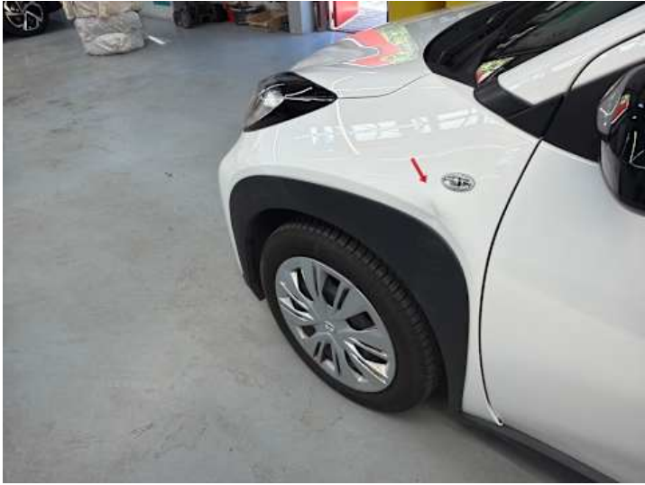
Kotflügel vorne links (Kratzer, Delle)
