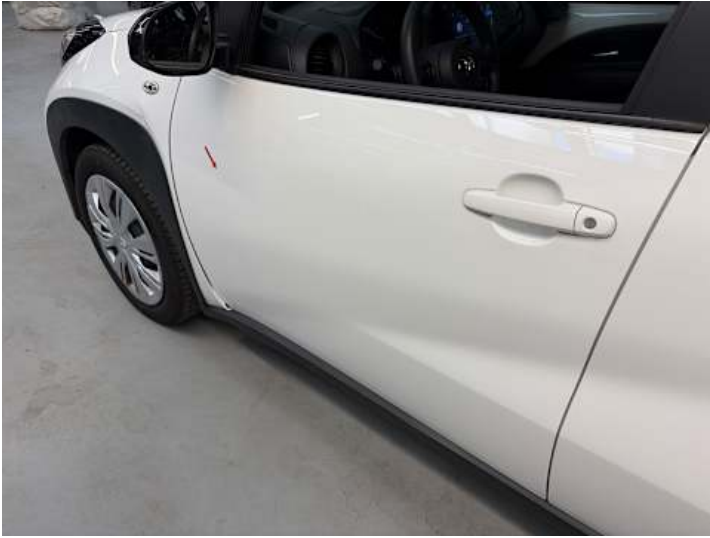
Fahrtür (Kratzer, Delle)
