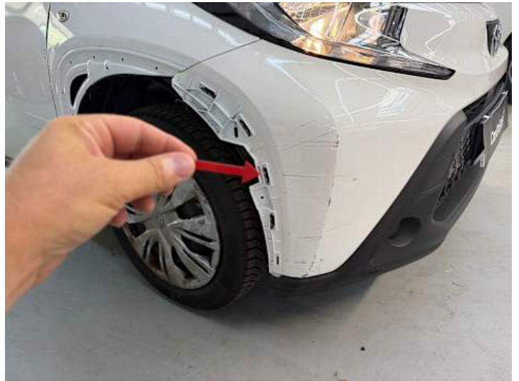
Stoßstange vorne (Kratzer, Riss/Bruch)
