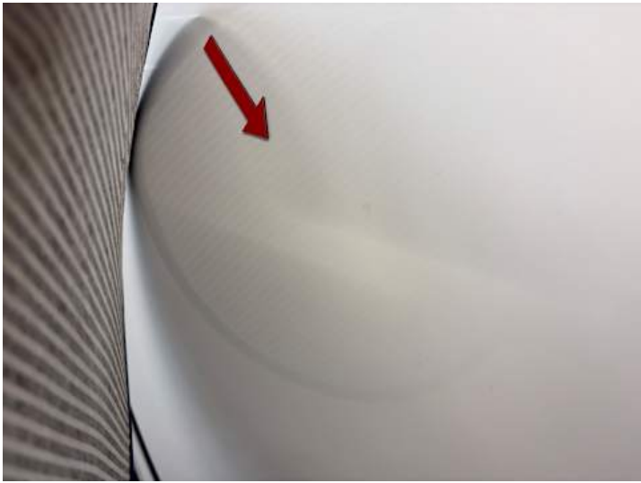
Fahrtür (Kratzer, Delle)
