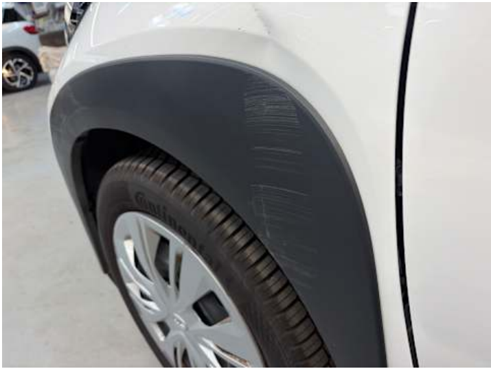
Kotflügel vorne links (Kratzer, Delle)
