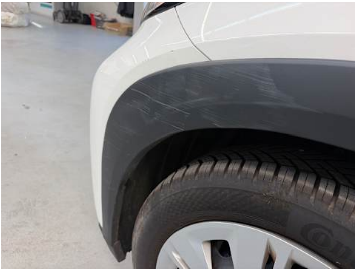
Kotflügel vorne links (Kratzer, Delle)
