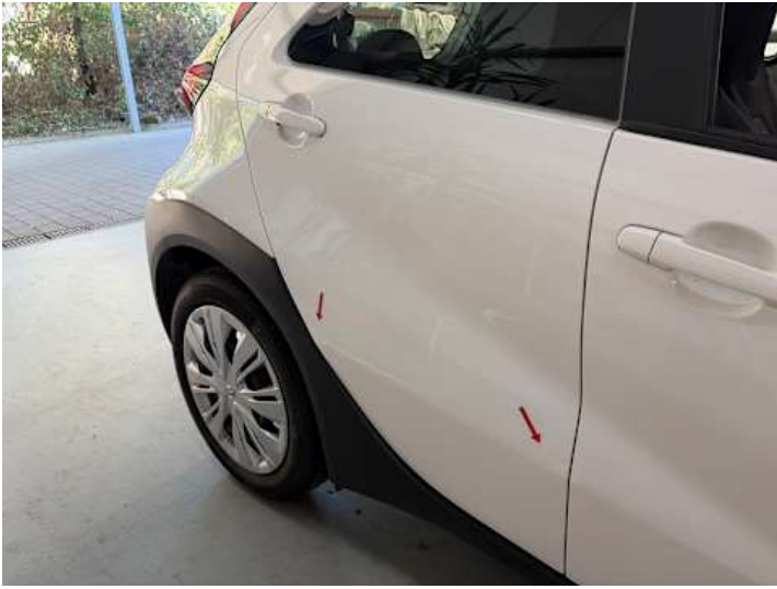
Türe hinten rechts (Kratzer, Delle)
