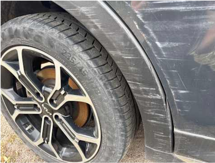
Seitenteil hinten rechts (Kratzer, Lackschaden, Verformung, Riss/Bruch)
