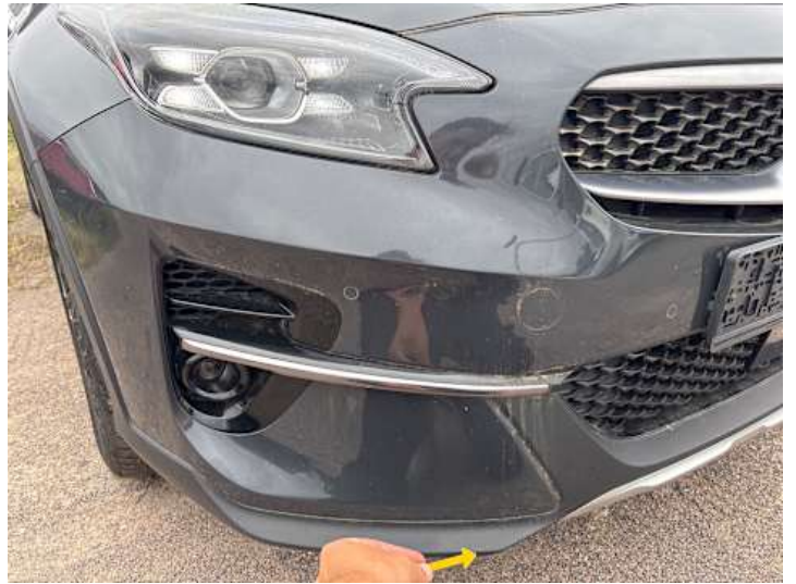
Stoßstange vorne (Kratzer, Verformung)
