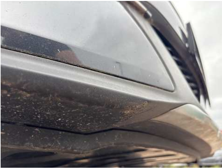
Stoßstange vorne (Kratzer, Verformung)
