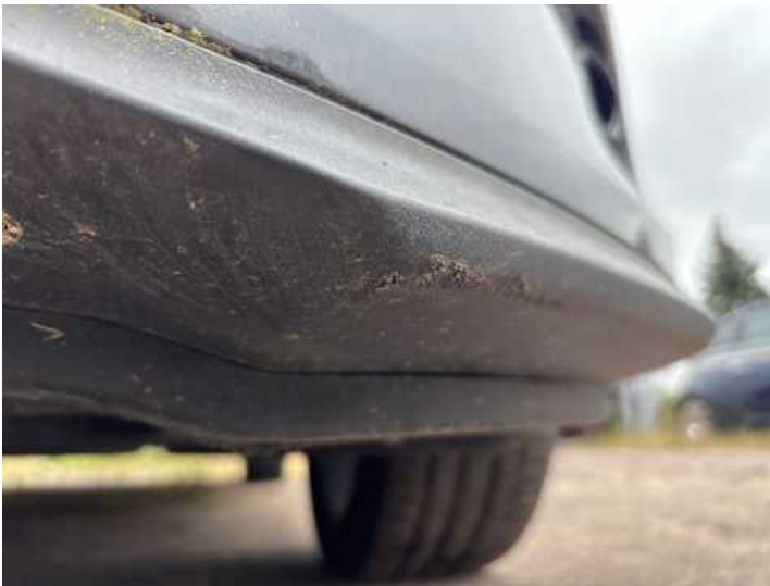
Stoßstange vorne (Kratzer, Verformung)
