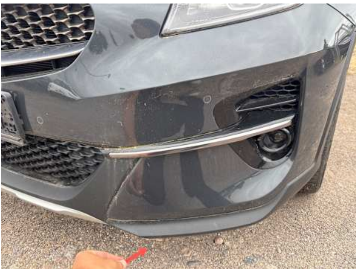
Stoßstange vorne (Kratzer, Verformung)
