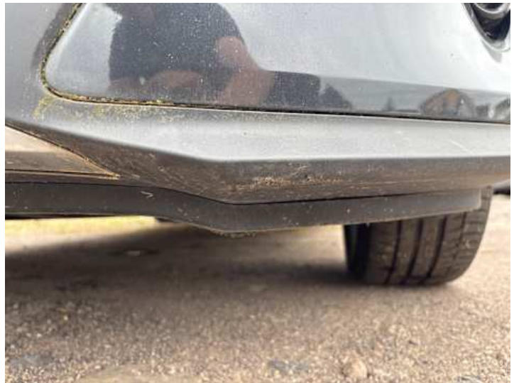
Stoßstange vorne (Kratzer, Verformung)
