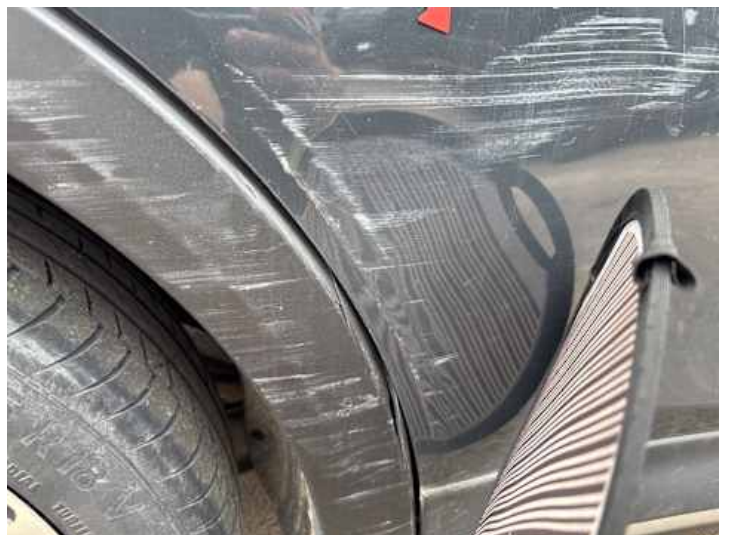
Türe hinten rechts (Kratzer, Lackschaden, Verformung)
