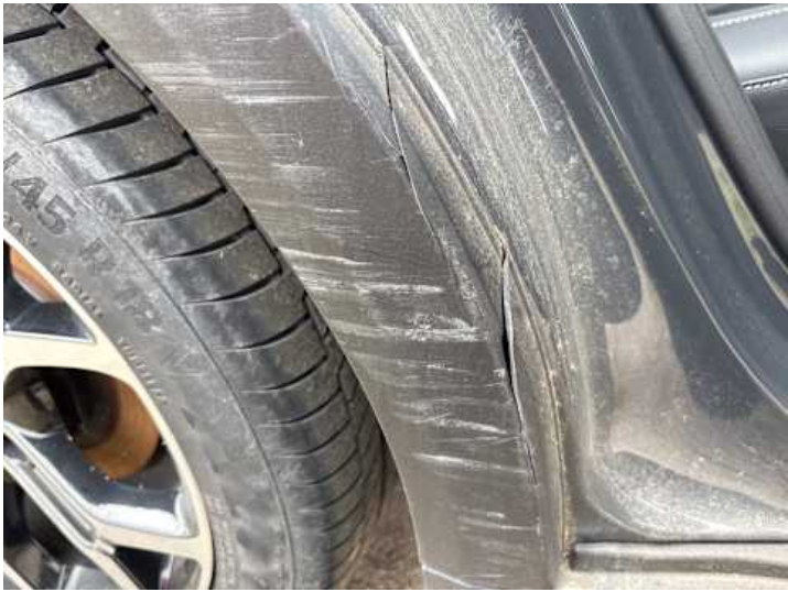
Seitenteil hinten rechts (Kratzer, Lackschaden, Verformung, Riss/Bruch)
