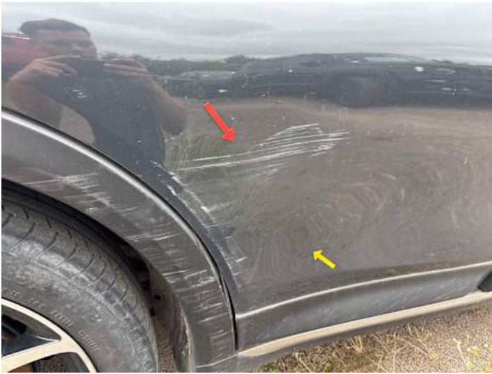
Türe hinten rechts (Kratzer, Lackschaden, Verformung)
