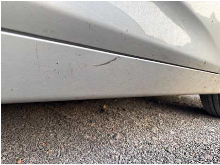
Schweller rechts (Kratzer)
