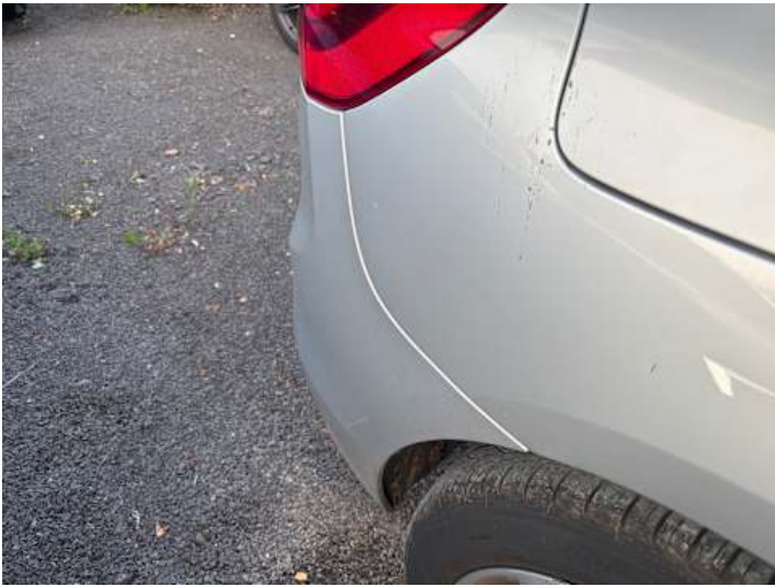
Stoßstange hinten (Unsachgemäß instand gesetzt)
