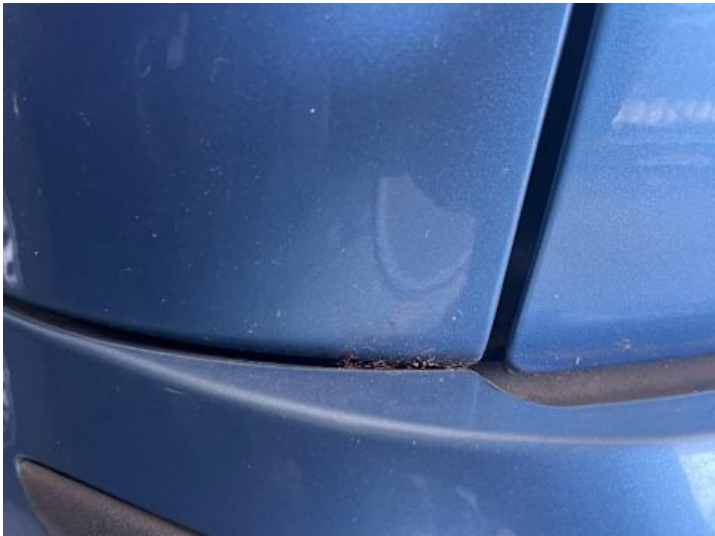
Seitenteil hinten links (Lackschaden, Rost)
