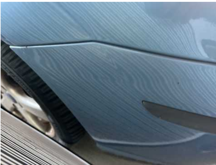
Stoßstange vorne (Verformung)
