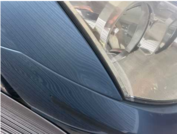
Kotflügel vorne rechts (Verformung)
