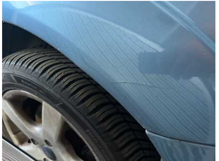
Kotflügel vorne rechts (Verformung)
