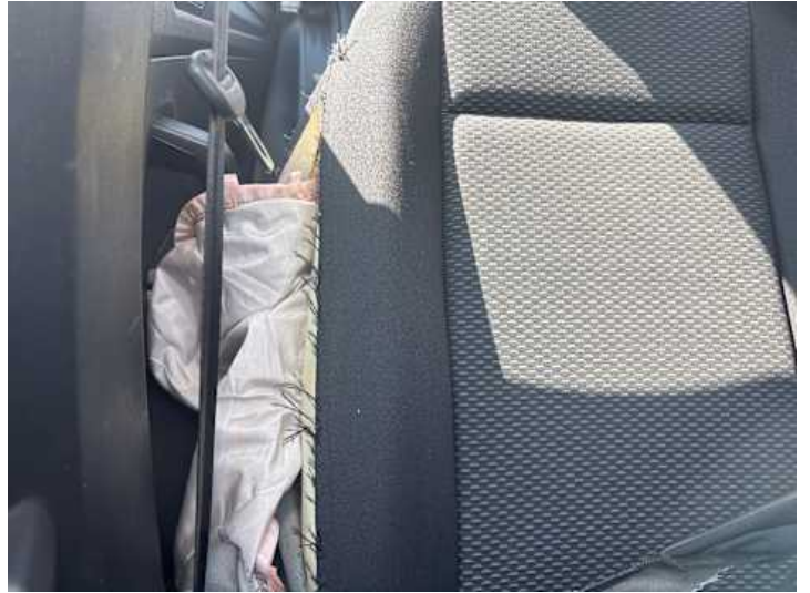
Innenraum (Airbag offen, Riss/Bruch)
