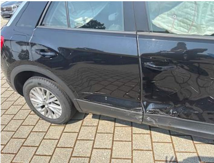
Türe hinten rechts (Lackschaden, Verformung)
