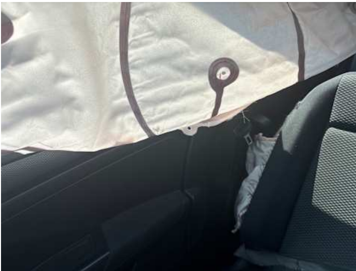
Innenraum (Airbag offen, Riss/Bruch)
