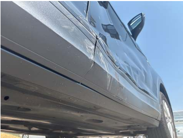
Schweller rechts (Verformung)
