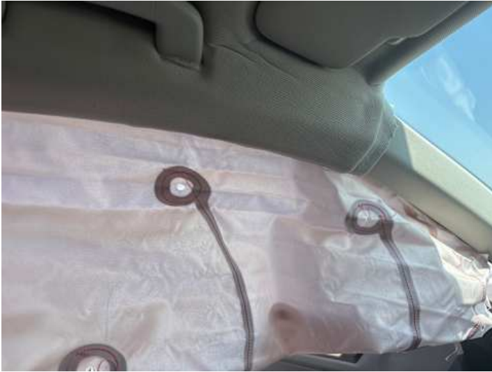
Innenraum (Airbag offen, Riss/Bruch)
