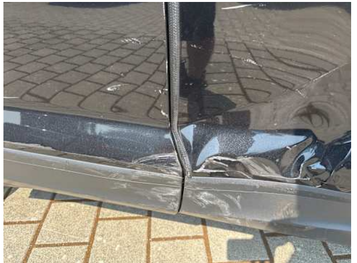
Türe hinten rechts (Lackschaden, Verformung)
