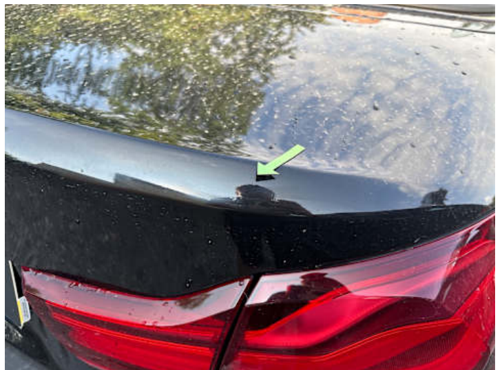
Heckklappe (Unsachgemäß instand gesetzt)
