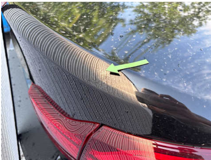
Heckklappe (Unsachgemäß instand gesetzt)
